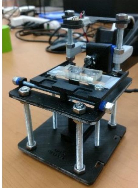
FIGURA 3-6. FOTOGRAFÍA DEL MODELO REALIZADO EN 3D Y ENSAMBLADO CON UNA MUESTRA COLOCADA EN LA PLATINA.
