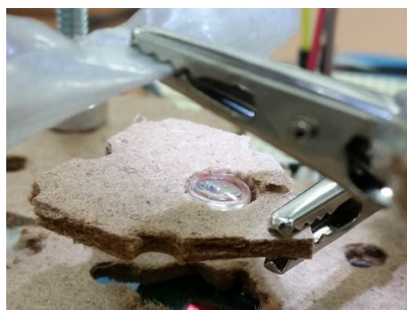
FIGURA 0-1. BASE DELENTE DE APUNTAOR LÁSER, EJEMPLO DE LOS FABRICADOS CON PROPÓSITOS DE PRUEBAS.
