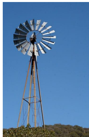
Figura 10.0: Molino de viento para bombeo de agua, California, EUA. Fuente: Randy Robertson, 2007.
