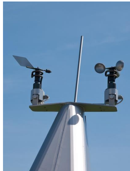
Figura 9.5: Veleta (izq.) y anemómetro (der.), parque eólico “Schwabhausen”, Schwabenhausen, Thüringen, Alemania. Fuente: Cornelius Bartke, 2009.
