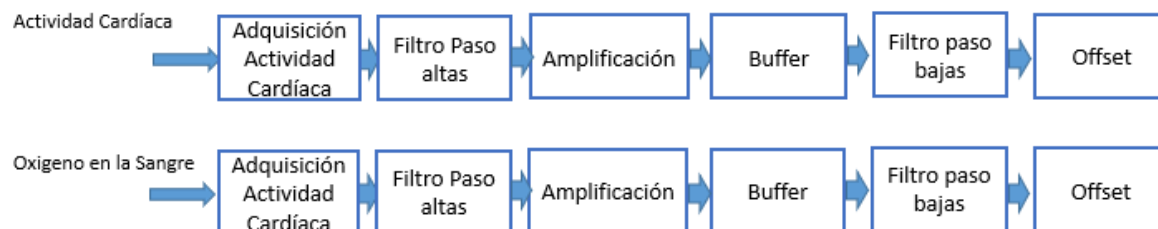
Ilustración 52: Diagrama de subsistema de frecuencia cardiaca y oxigenación.
