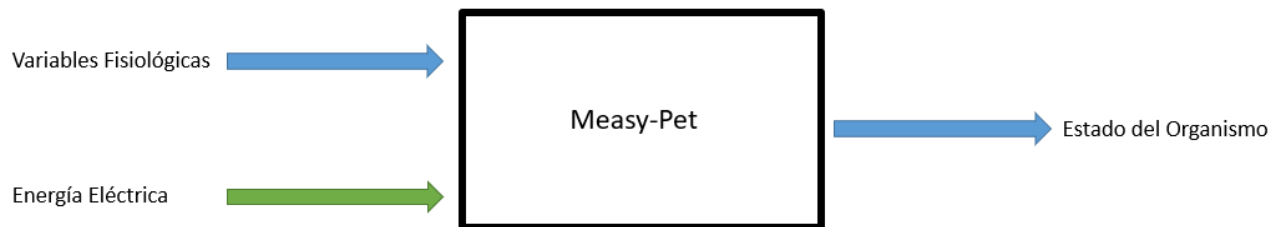
Ilustración 39: Diagrama de Caja Negra. Las Líneas azules son las que corresponden al flujo de información y las líneas verdes corresponden al flujo de energía.
