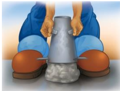
Imagen 11-8. Levantamiento del cono estándar de revenimiento. 115
