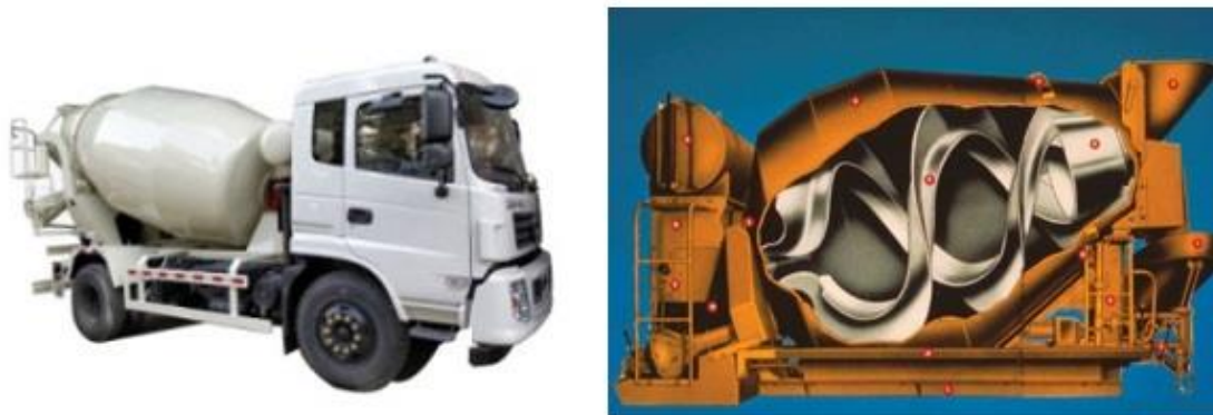
Imagen 6-5. Camión agitador y corte longitudinal del interior. 66
