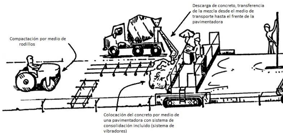
Imagen 6-22. Colocación de concreto por medio de una pavimentadora. 82
