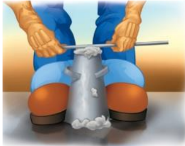
Imagen 11-7. Enrasado de la mezcla en cono estándar de revenimiento. 114
