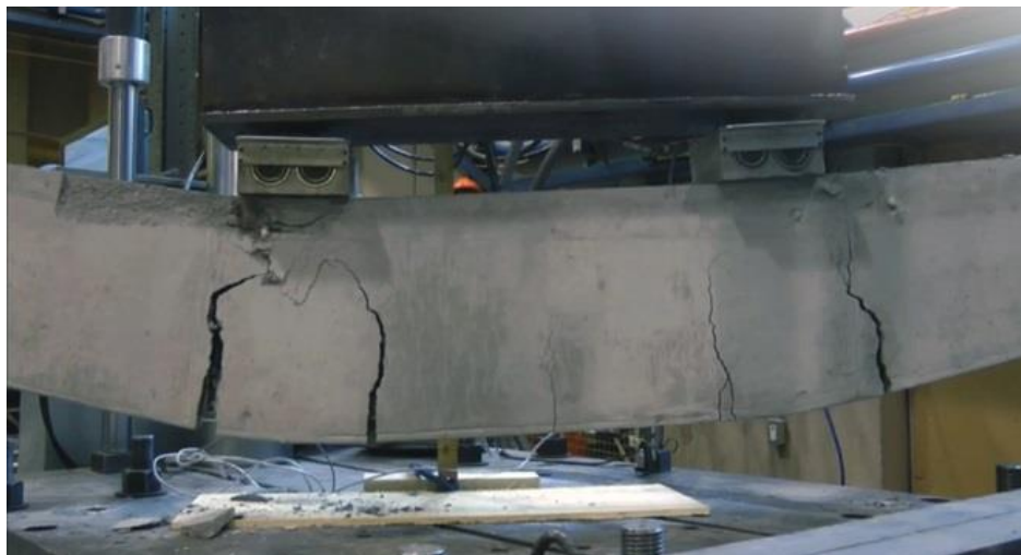
Imagen 11-27. Falla de viga de concreto sometida a flexión. 138
