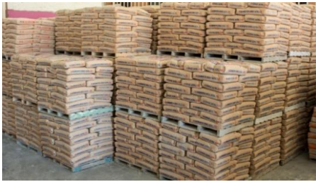
Imagen 2-4. Almacenamiento de sacos de cemento. 19
