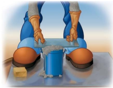
Imagen 11-12. Enrasado de la mezcla. 120
