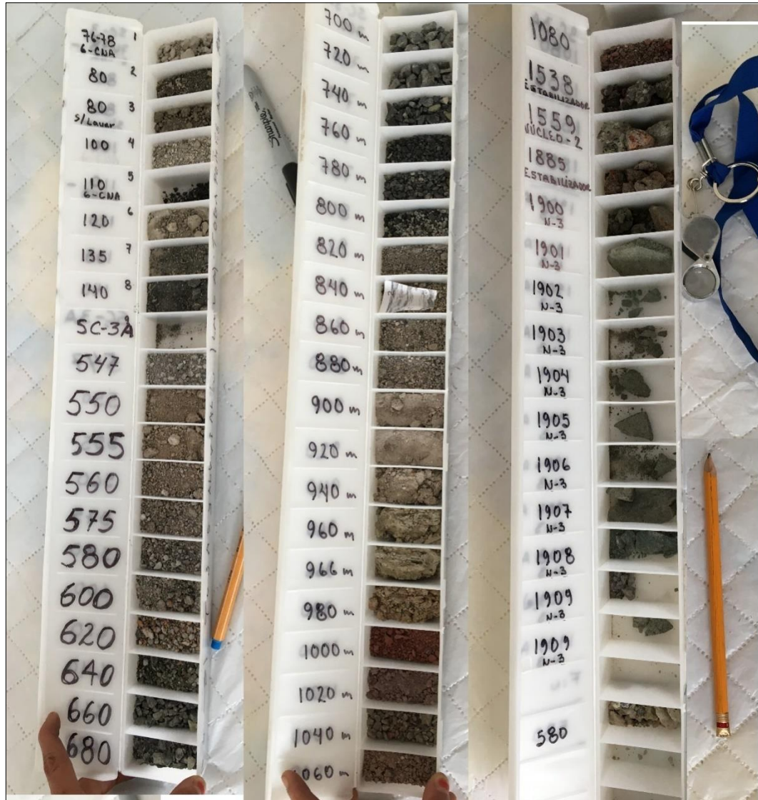
Figura 12 Recortes de roca del pozo Santa Catarina 3ª las cuales fueron utilizadas en esta fase de construcción de columna litológica. Muestras propiedad de SACMEX.
