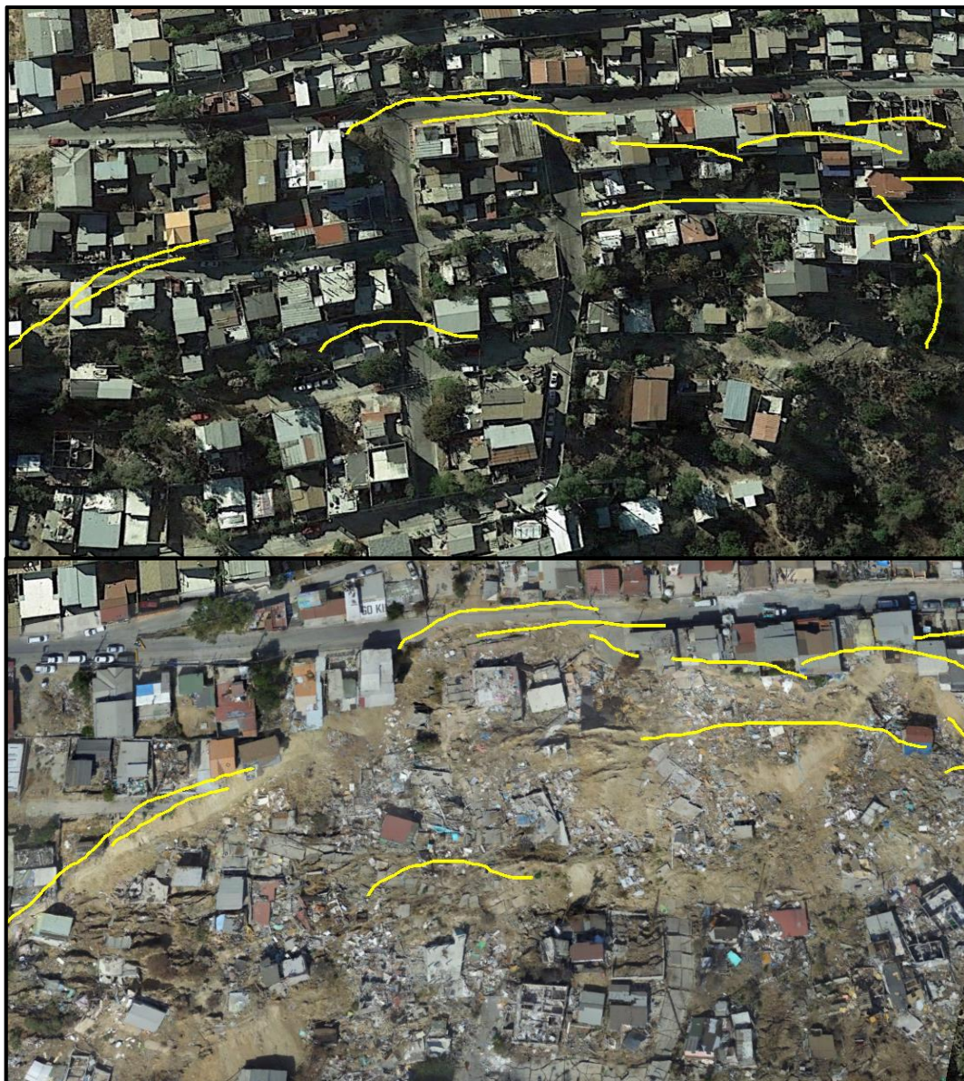
Figura 30. Grietas de tensión registradas antes del evento del 2018 en Lomas del Rubí (Imagen superior) (Dirección de Protección Civil Municipal). Fotogrametría tomada del deslizamiento (Imagen inferior).
