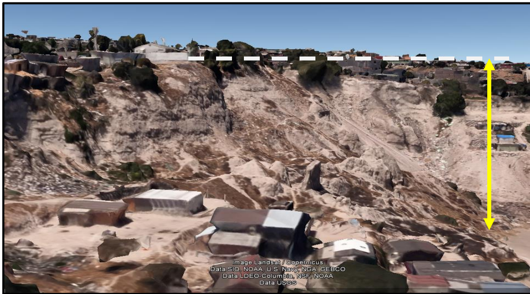
Figura 21. Altura y pendiente pronunciada de la ladera afectada por un movimiento en junio de 2018 en la colonia Anexo Reforma en Tijuana, B.C (Imagen obtenida de Google Earth).
