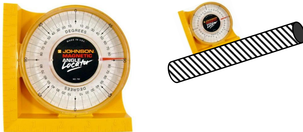
Figura 47. Buscador comercial de ángulos (Porter, s.f.).
