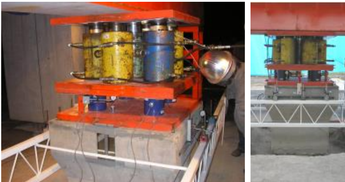
Figura 4.8 Ejemplo de arreglo general de gatos hidráulicos, celdas de carga, indicadores de carátula y transductores de desplazamiento en el cabezal de la pila de prueba.
