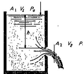
Figura 6-1 Ilustración de un orificio
