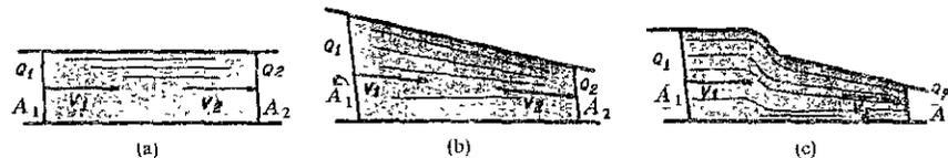
Figura 5-1. (a) Uniforme.  $Q_1 = Q_2$ ;  $A_1 = A_2$ ;  $V_1 = V_2$ . (b) Acelerado.  $Q_1 = Q_2$ ;  $A_1 \neq A_2$ ;  $V_1 \neq V_2$ . (c) Movimiento variado.  $Q_1 \neq Q_2$ ;  $A_1 \neq A_2$ ;  $V_1 \neq V_2$
