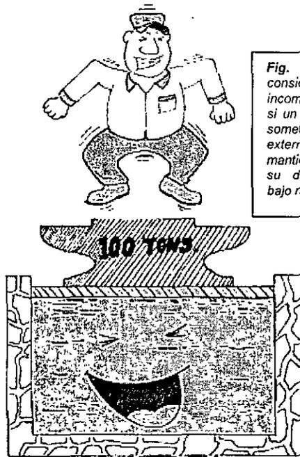
Fig. 2.3 El agua es considerada como un fluido incompresible, es decir que si un volumen de agua se somete a una fuerza externa, dicho volumen se mantiene constante, o bien su densidad no cambia bajo ninguna circunstancia.
