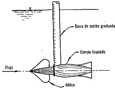
Figura 4.16. Molinete hidráulico.
