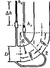
Figura 9.7. Aforador de codo.
