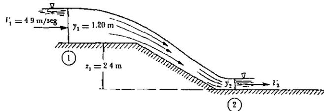
Figura 4.25. Flujo en la caída de un canal.
