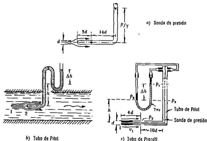
Figura 4.15. Medidores de presión y velocidad.
