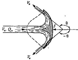
Figura 4.32b. Incidencia de un chorro contra un cangilón.
