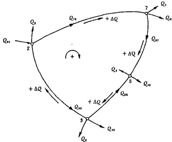
Figura 9.23. Circuito elemental en una red cerrada.
