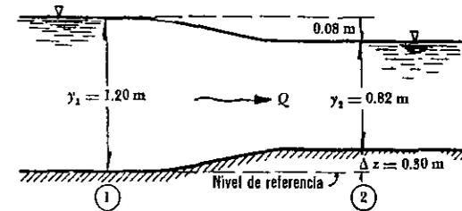
Figura 4.24. Flujo en la contracción de un canal.
