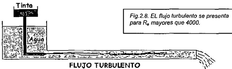
Fig.2.8. EL flujo turbulento se presenta para  $R_e$  mayores que 4000.
