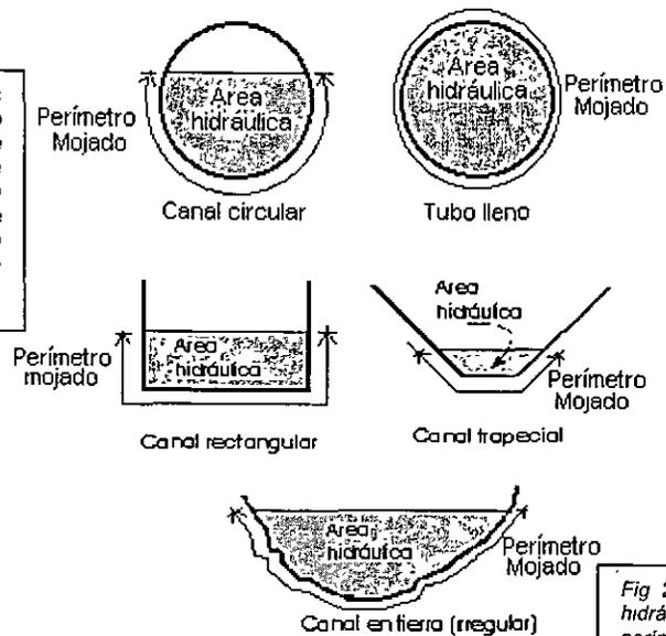
Fig 2.4. Área hidráulica y perímetro mojado en conductos
