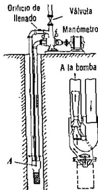
Antes de abrir la válvula se arranca la bomba y se lee en el manómetro de vacío la presión negativa necesaria
