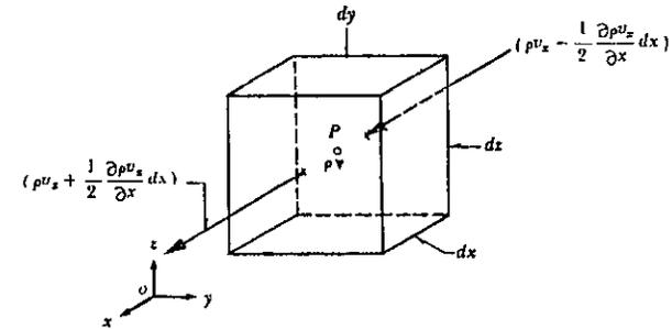
Figura 4.1. Derivación de la ecuación diferencial de continuidad.
