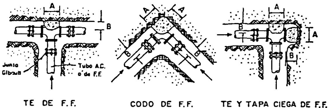
Figura 8.7. Dirección de los empujes y forma de colocar los atraques.
