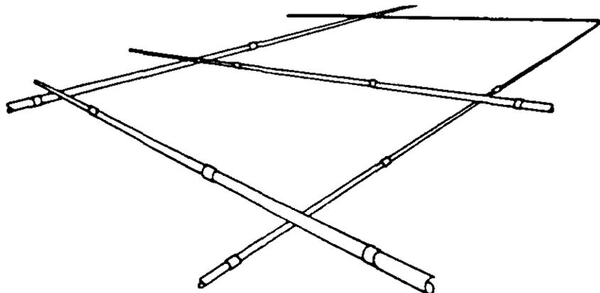
Figura 8.4. Tuberías secundarias a desnivel en los cruces interiores en un circuito.
