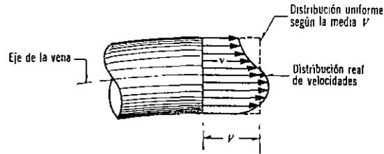
Figura 4.7. Distribución de velocidades en una sección.
