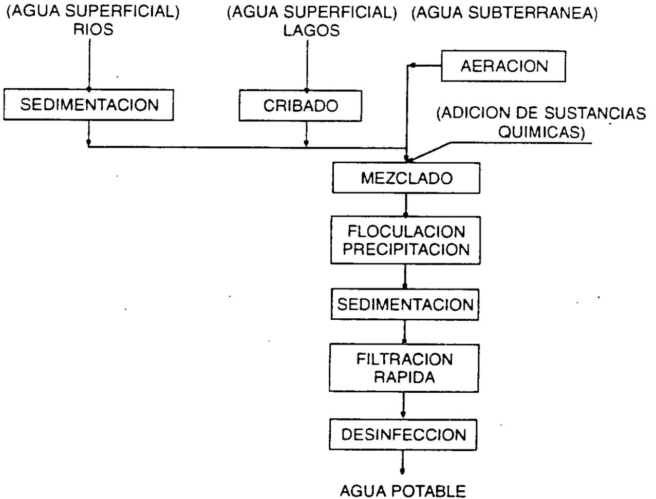
Figura 2.5 Diagrama de flujo de una planta de tratamiento convencional para agua potable.
