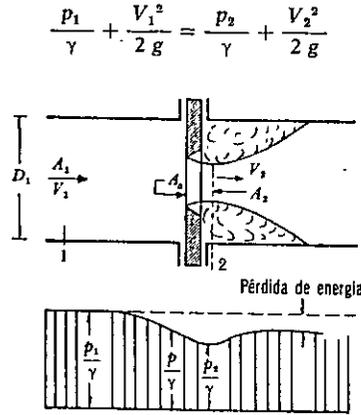
Figura 9.3. Diafragma en una tubería.
