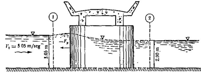
Figura 4.29. Esquema aclaratorio del flujo del problema 4.15.
