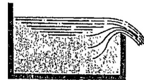
Figura 6-2 Esquema de un vertedor
