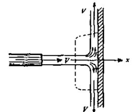
a) Incidencia de un chorro contra una placa. b) Incidencia de un chorro normal a la placa.
