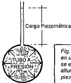
Fig. 2.10 El agua en un tubo a presión se eleva hasta una altura llamada carga piezométrica.
