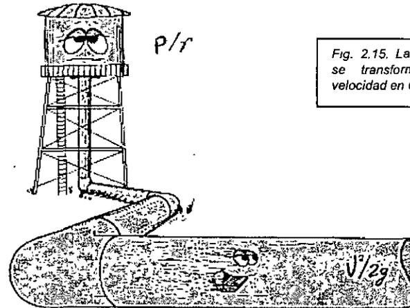
Fig. 2.15. La carga piezométrica se transforma en carga de velocidad en un flujo de agua.
