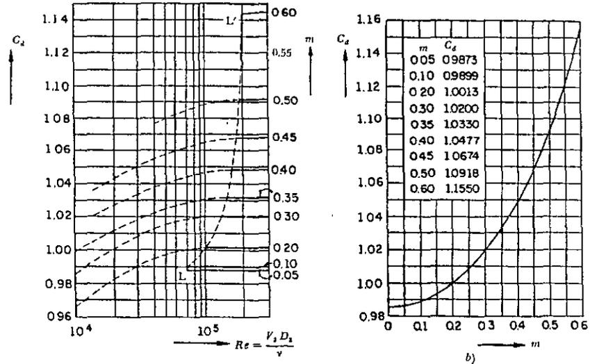
Figura 9.2. Coeficiente  $C_d$  para un venturímetro (Ec. 9.4).
