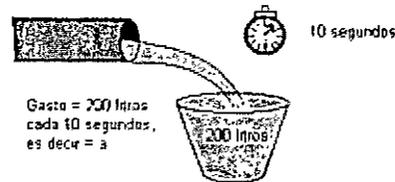
Fig. 3.6. El método volumétrico para medir el gasto es sencillo y de los que pueden resultar más exactos.
