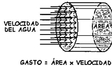
Fig. 2.14. El principio de continuidad establece que el agua que atraviesa cualquier sección del conducto en el tiempo, es constante
