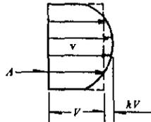
Figura 4.13. Distribución de velocidades en una sección.
