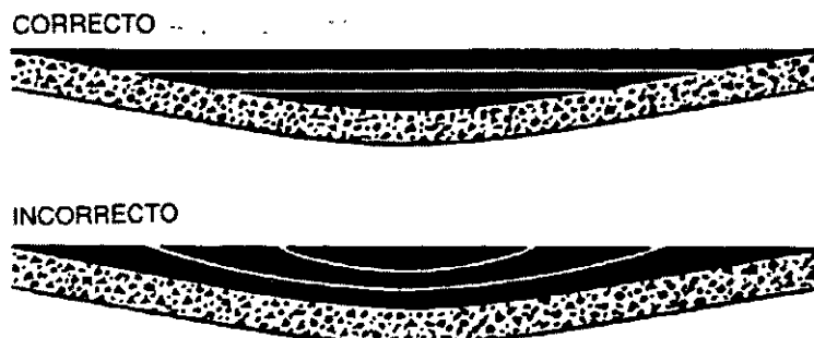
Figura 5.3 - Una Colocación Correcta de Capas de Enrase Garantiza un Pavimento Liso.
