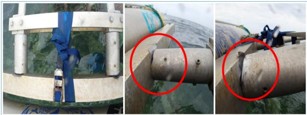
**Figura 50.-** Pieza de unión boya-brazo del WEC MICO-1T desgastada por fricción
