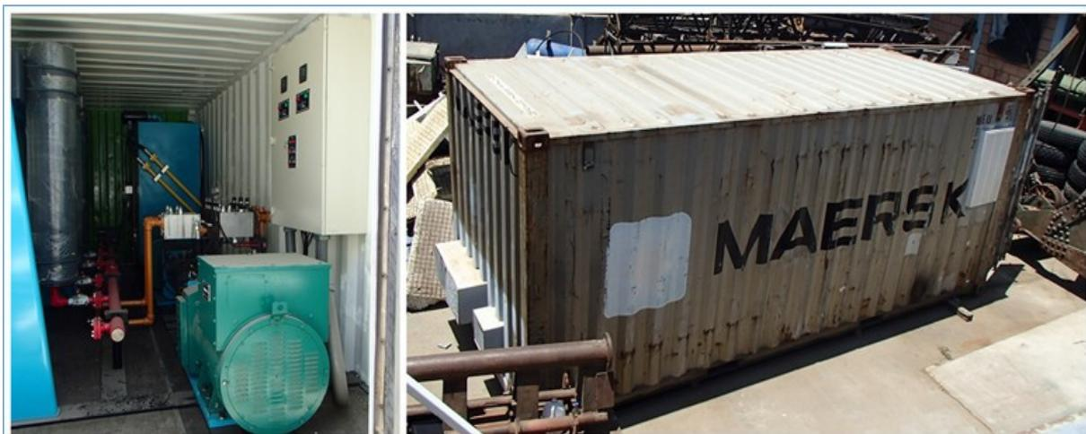
Figura 35.- Sistema de conversión y generación de energía del WEC DINA-EF
