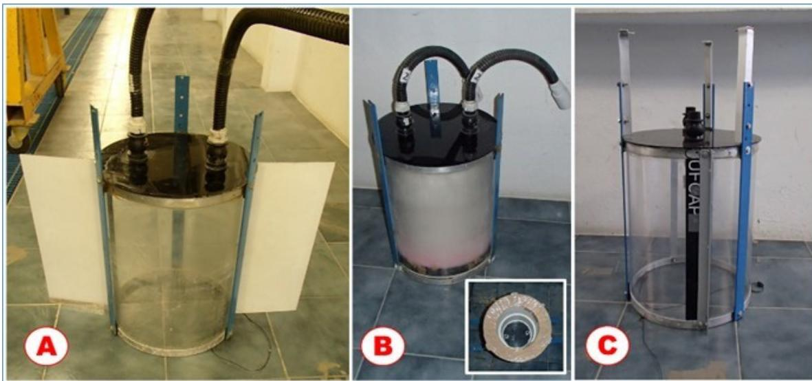
Figura 10.- Cámaras OWC evaluadas en laboratorio
