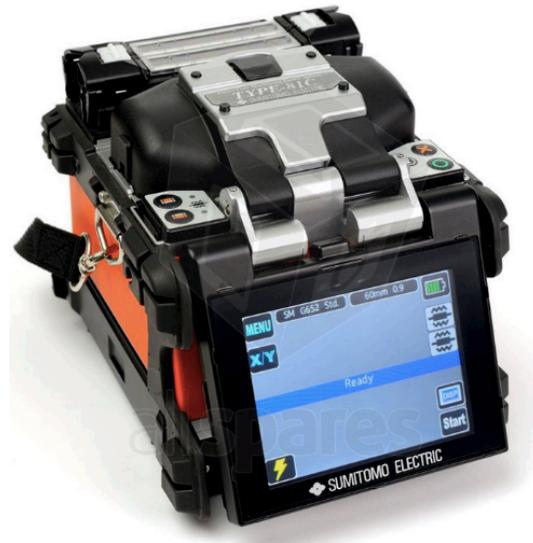
Figura 2.14 Empalmadora de fusión[10]
