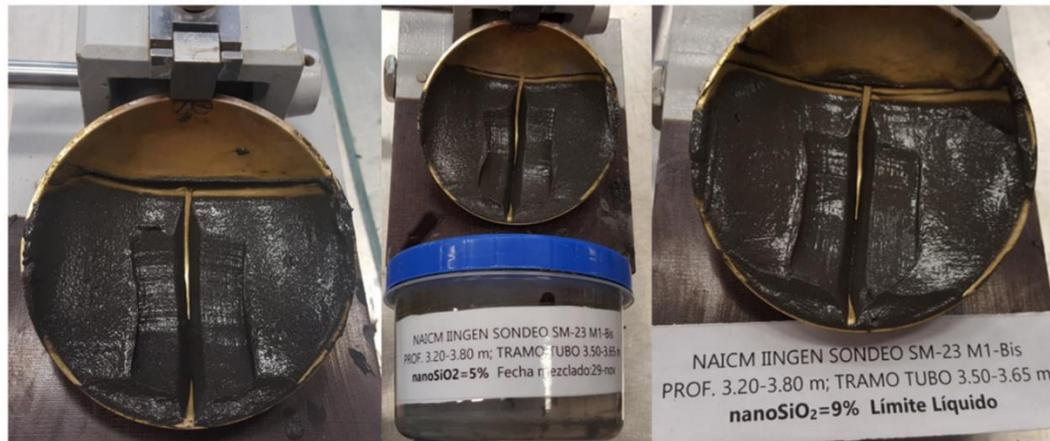
*Figura 4.3 Obtención del límite líquido con la copa de Casagrande.*
