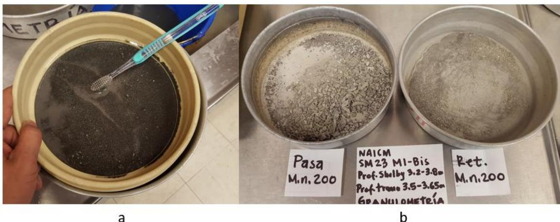
**Figura 6.15** Desarrollo de la prueba de granulometría para el primer subconjunto de B. a) Lavado de la muestra. b) Suelo que pasó la malla No. 200 y suelo que no pasó la malla No.200.
