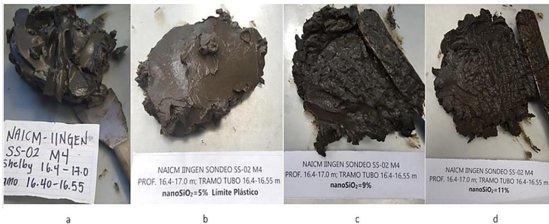
**Figura 6.16** Segundo subconjunto de B. a) Suelo en estado natural. b) Muestra con 5% de nanoSiO<sub>2</sub>. c) Muestra con 9 % de nanoSiO<sub>2</sub>. d) Muestra con 11 % de nanoSiO<sub>2</sub>.
