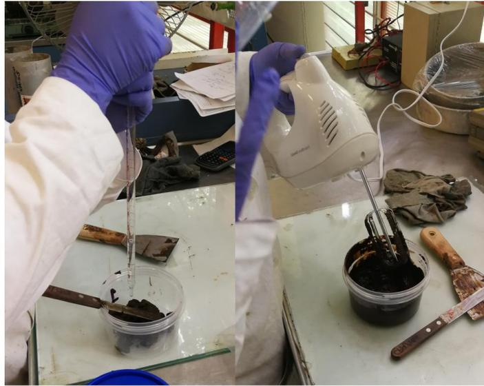
Figura 6.17 Preparación de las muestras nanomodificadas con nanoSiO<sub>2</sub>: etapa de mezclado.
