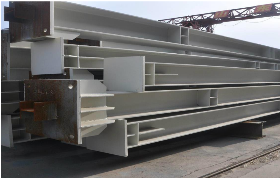
Imagen 7.4 Almacenaje de columnas de Rack de Tuberías
