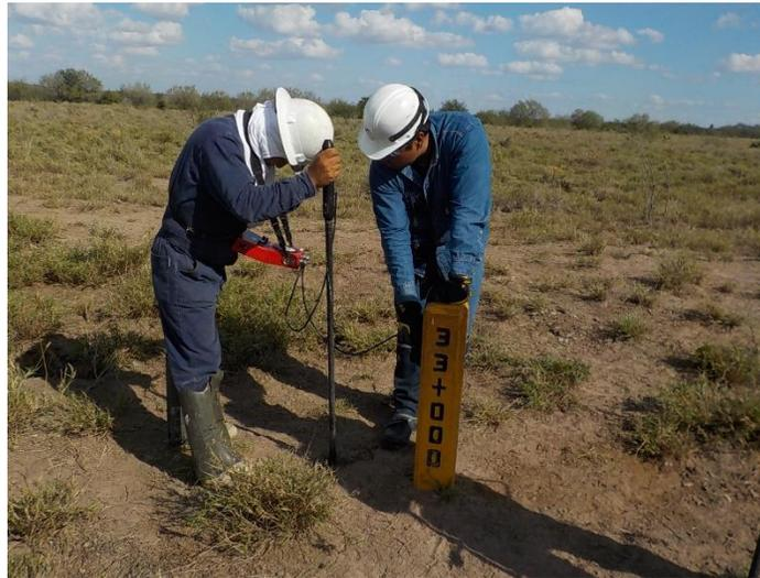
Entre mayor resulta dicha intensidad de señal, mayor es el nivel de detección que se obtiene respecto a defectos de recubrimiento pequeños. En las zonas en donde se obtuvo una intensidad de la señal menor a 200 mV, se instalaron sistemas temporales para incrementar dicha señal.
