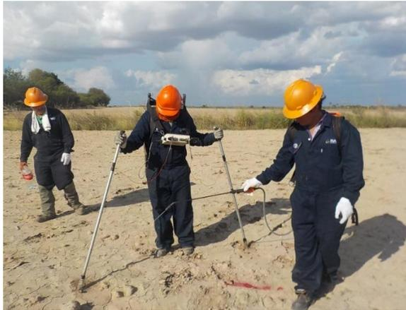
Durante el levantamiento del perfil de potenciales se humecta el suelo para asegurar un buen contacto de las celdas y obtener así lecturas confiables.
