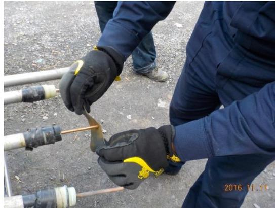
El mantenimiento diario de las celdas de cobre sulfato de cobre es primordial para garantizar lecturas confiables de los potenciales *On* y *Off*.
