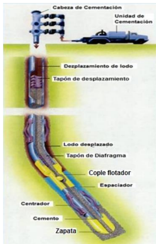
Figura no. 7, "Esquema general de cementación", Tesis cementación de pozos horizontales Huerta Rosales Miguel Ángel.
