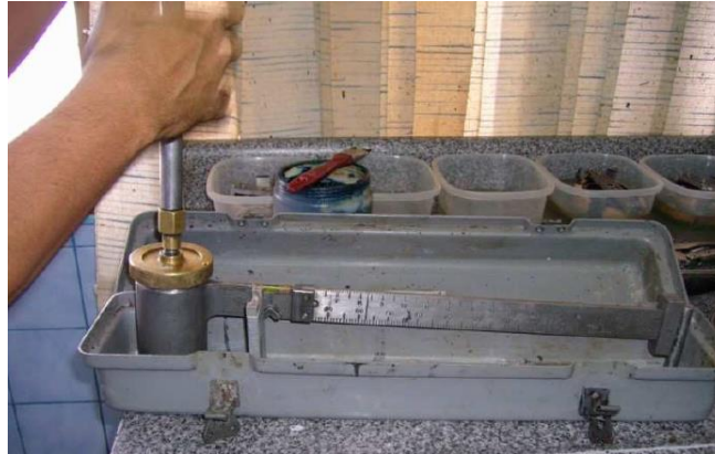
Figura no. 2, “Medición de la densidad en balanza presurizada”, Manual de terminación de pozos FI UNAM.
