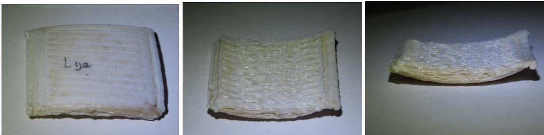
Figura 59. Prueba realizada utilizando lija como base.
