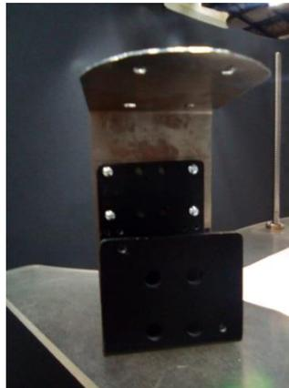
Figura 45: Sujetador preliminar del mecanismo de extrusión
