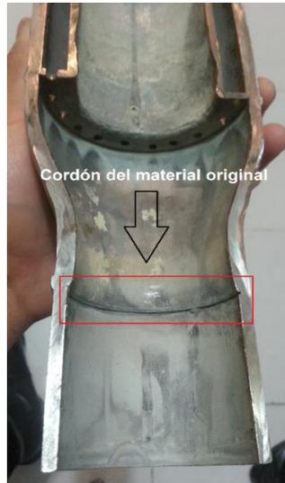
**Figura 67.** Cordón de soldadura observado mediante microscopia de barrido y estereoscopio.
