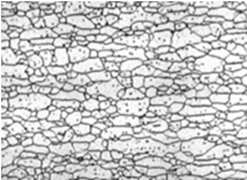
**Figura 8.** Tira de acero inoxidable (ferrítico) tipo 430 recocido a 788°C (1450°F). La estructura de matriz de ferrita con grano equiaxial y partículas de carburo. (López Ochoa, 2014)
