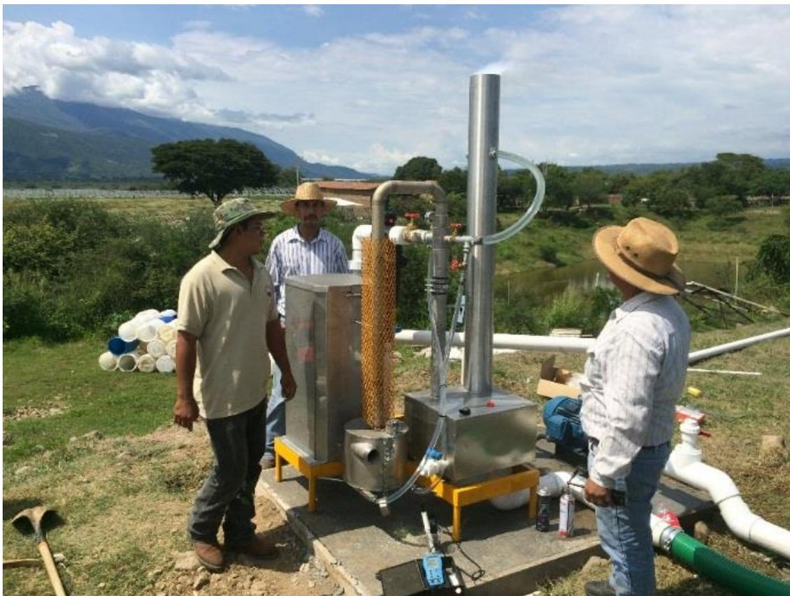
**Figura 21** Sistema empleado en la fabricación de ácido sulfuroso.
