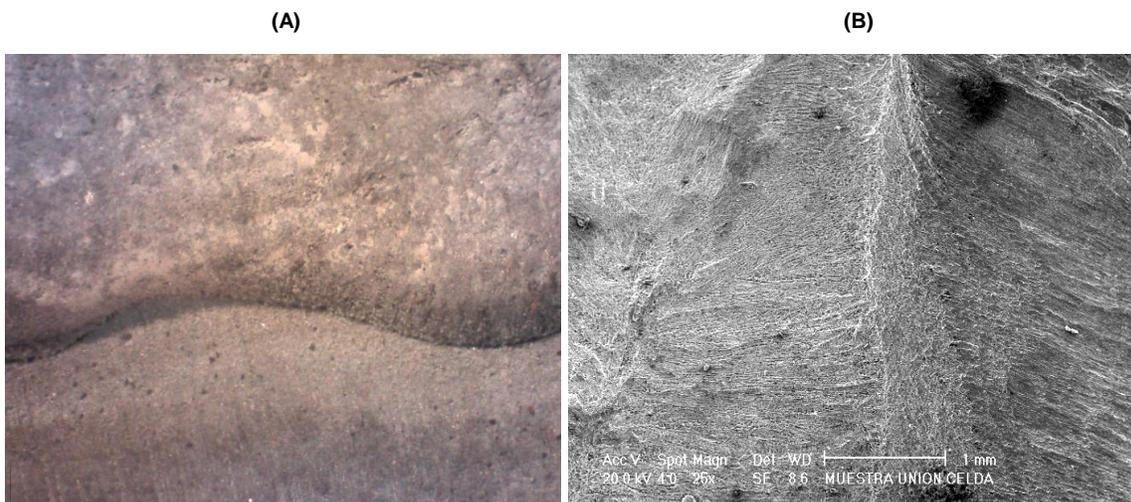
**Figura 67.** Morfología del cordón de soldadura vista mediante microscopía óptica (A) y MEB (B) a 25x.
