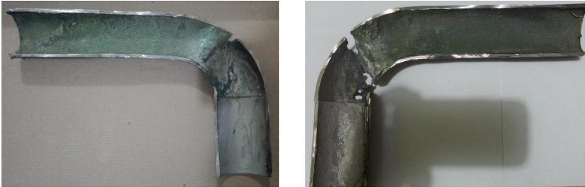
**Figura 22.** Corte longitudinal del “Codo”
