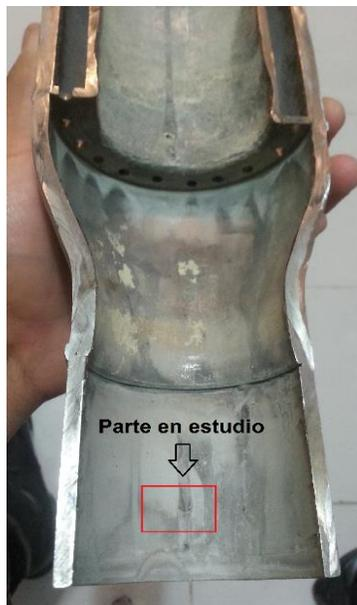
**Figura 45.** Identificación de la zona en estudio en la pieza “Celda” mediante microscopía óptica.
