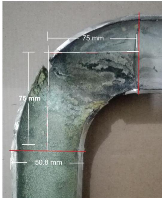
**Figura 70.** Dimensiones de diseño registradas en el codo de 90° radio corto
