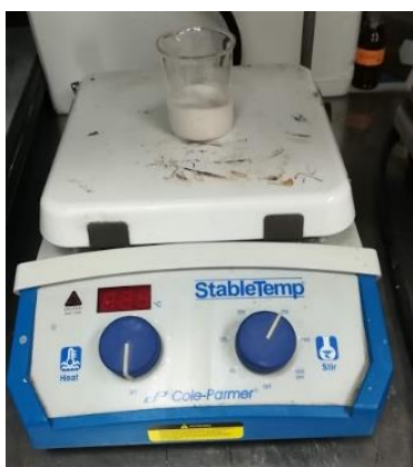
Figura 38. Disolución de CaO a temperatura de 18°C Durante 5 min
