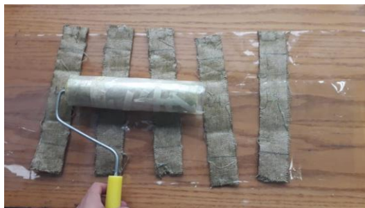
Figura 42. Forma correcta de utilización de rodillo para recubrimiento de BP3
