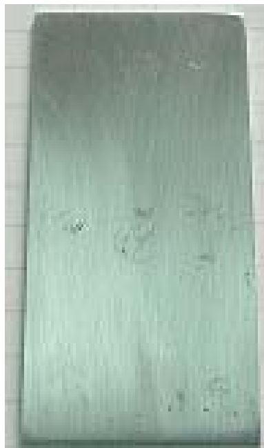
Fotografía 33 Probeta 4 antes de exposición en cámara salina parte anterior.
