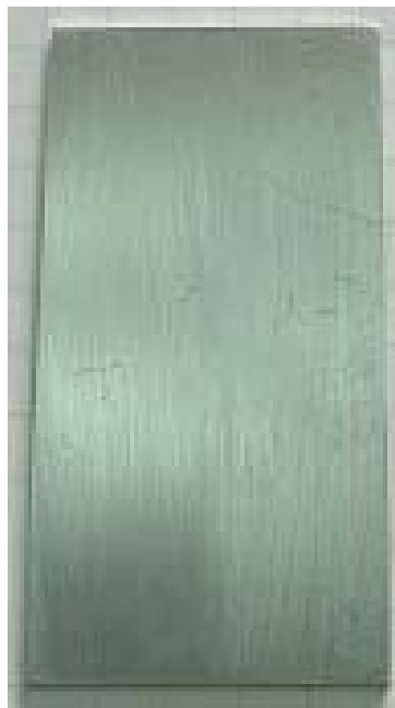
Fotografía 34 Probeta 4 antes de la exposición en cámara salina parte posterior.
