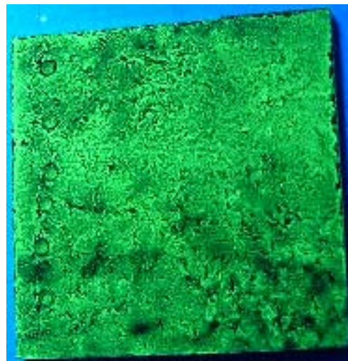
Fotografía 26 Probeta después de aplicar revelador limpiando exceso y dejando secar, vista con luz ultravioleta.
