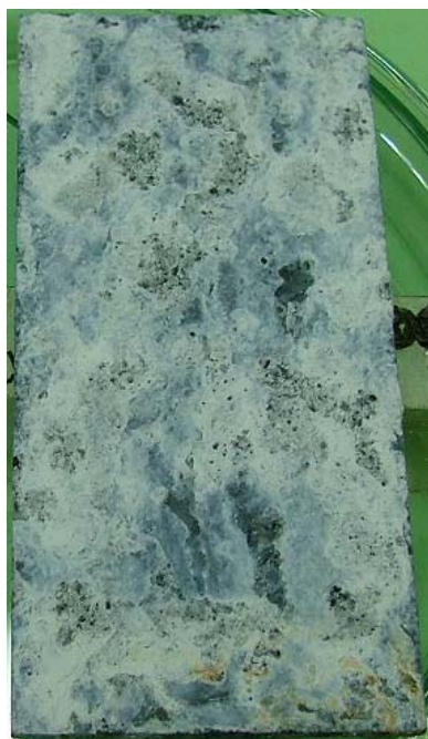
Fotografía 35 Probeta 4 después de exposición en cámara salina.
