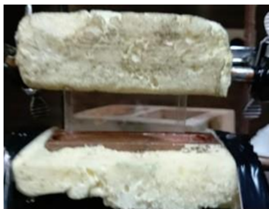
Figura 13: Dispositivo experimental, celda de Hele-Shaw montada y en contacto con el fluido de trabajo.
