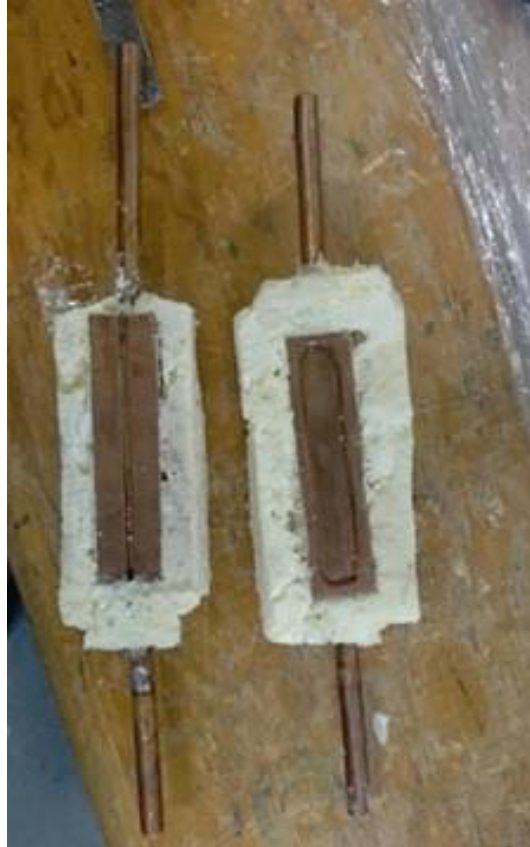
Figura 12: Barra de cobre superior e inferior para la sujeción del celda de Hele-Shaw y calentamiento del fluido de trabajo.
