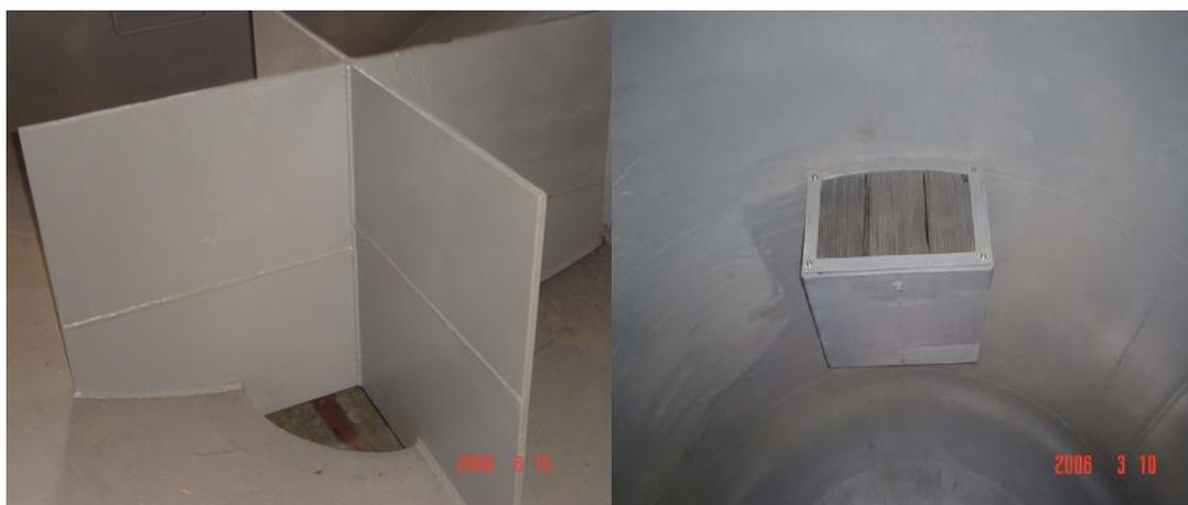
*Figura 4.9 Esquema de un rompedor de vórtice (lado izquierdo) y un separador de niebla tipo Housing (lado derecho).*
