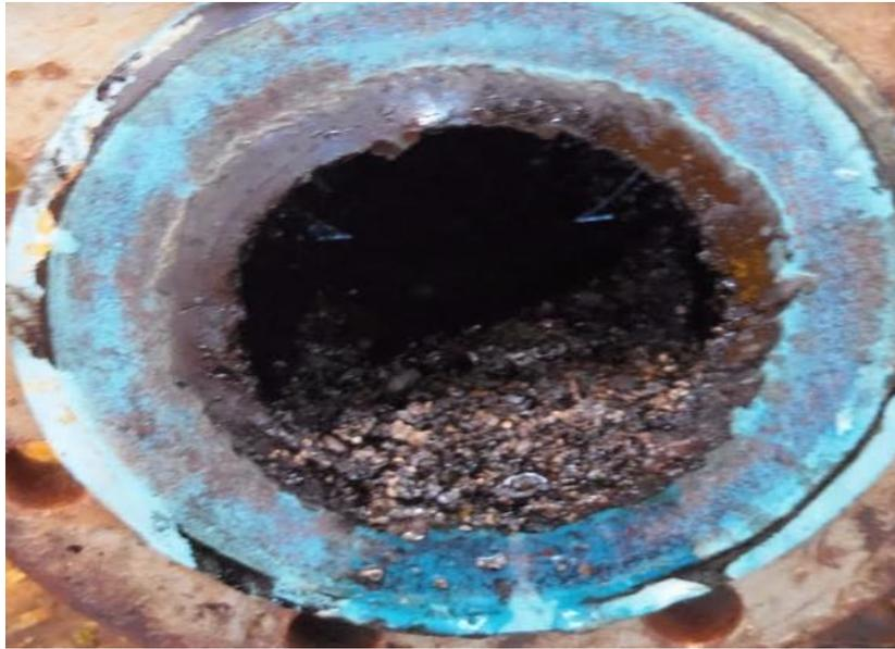
Figura A.6 Deposición de sedimentos y residuos orgánicos en líneas de proceso superficiales.
