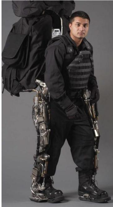
**Fig. I.4** Diseño final del BLEEX [1].
