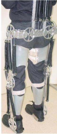
**Fig. I.10** Prototipo del Exoesqueleto de miembro inferior.
