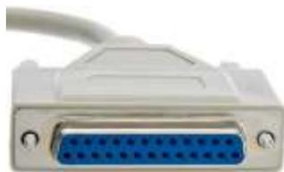
Fig. 55. Conexión DB25
