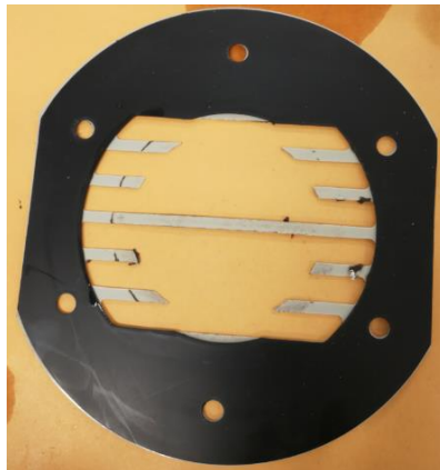
Figura 58 Promotor de turbulencia
