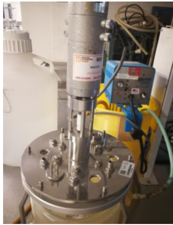
Figura 11 Agitador con controlador, Applikon ADI 1012
