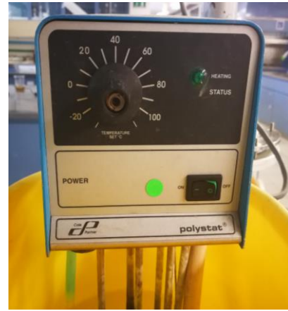
Figura 12 Calentador de circulación por inmersión, Polystat 12112-00
