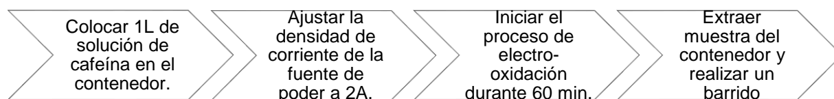
Figura 20 Diagrama de flujo para la degradación de cafeína en la celda electroquímica
