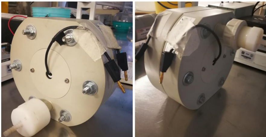
Figura 9 Celda electroquímica DiaCell® 106
