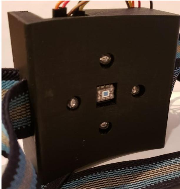
*Figura 66.* Encapsulado de la PCB del OPT101
