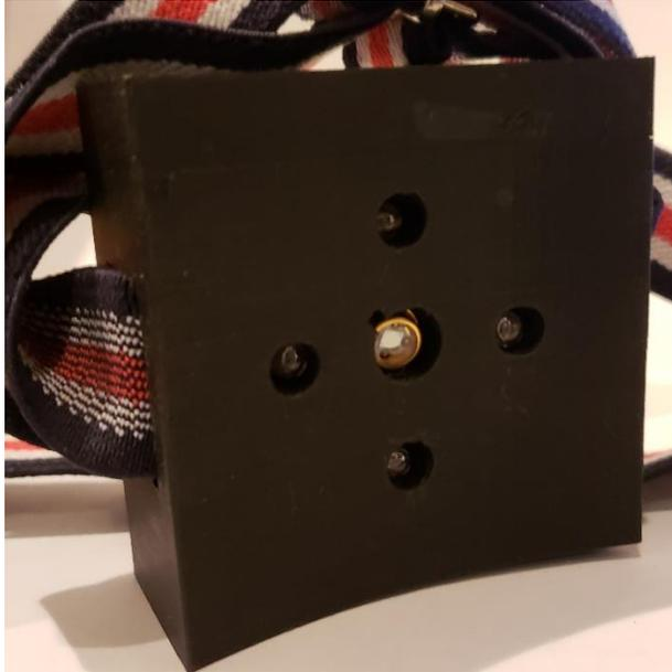
*Figura 65.* Encapsulado de la PCB del ODA-5W-100K
