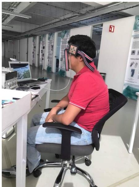
*Figura 72.* Carcasa colocada en la CdLPFI con sujeción de elástico para mayor libertad.
