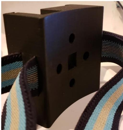
*Figura 61.* Vista inferior de la carcasa del OPT101
