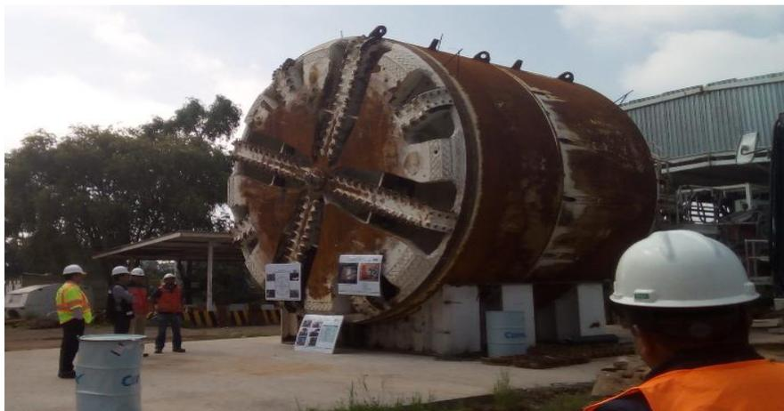
Figura 5.4.- Visita a sitio de equipos para excavación de túneles. Rueda de corte para exhibición (autoría propia).
