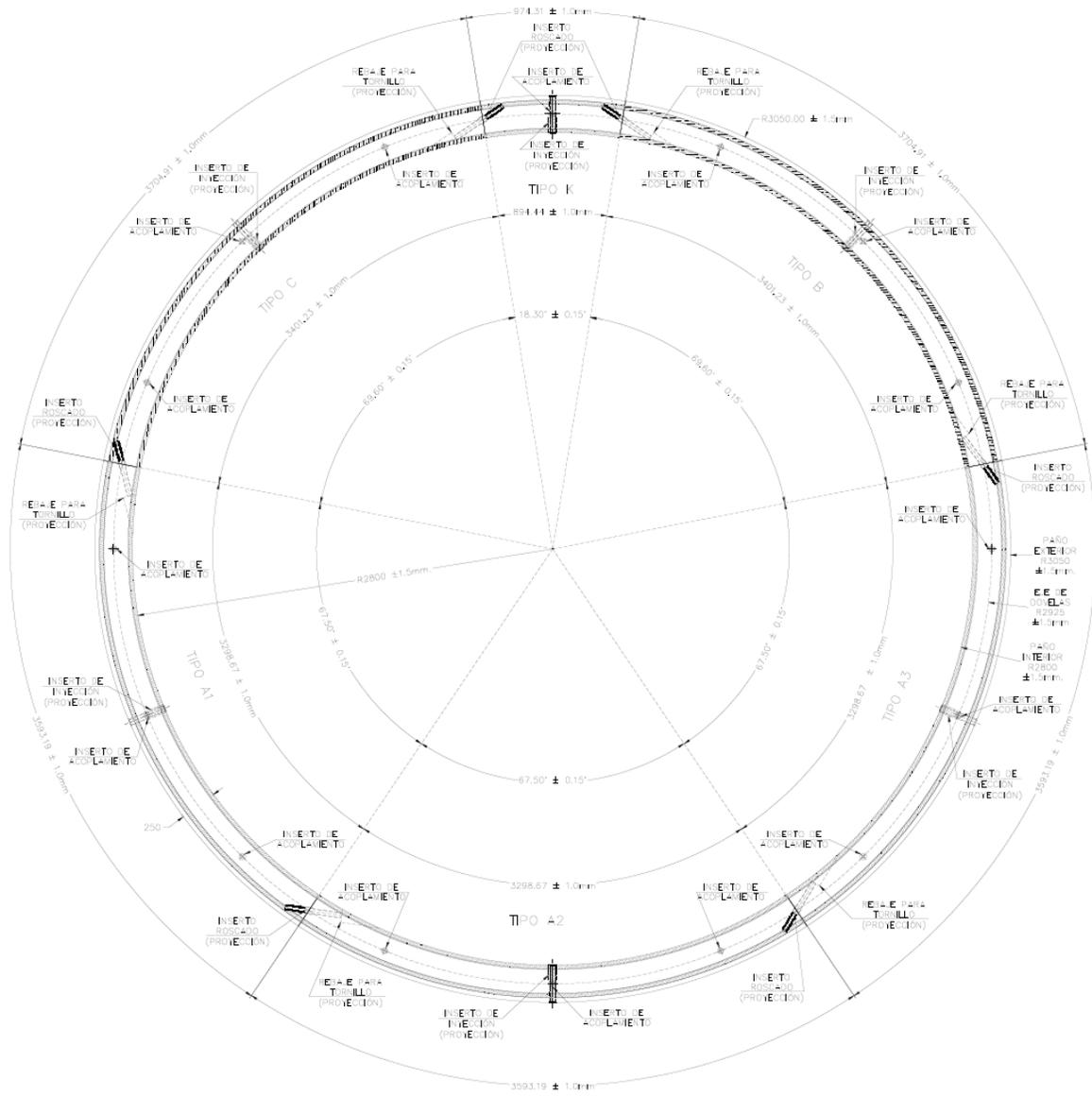
Figura 5.12.- Distribución de dovelas para formar un anillo.
