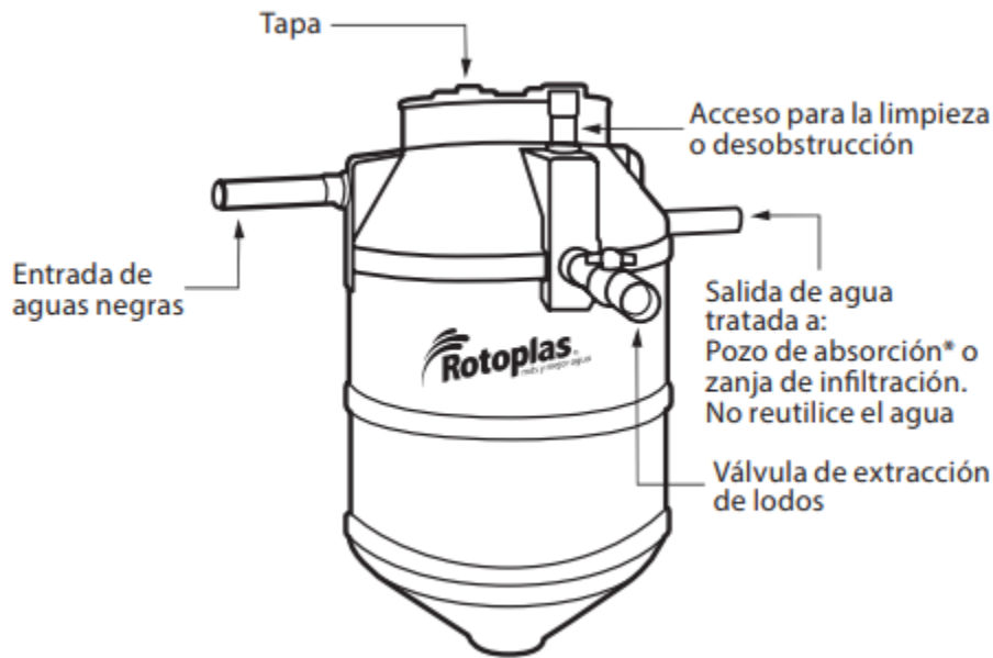
Figura 4-6 Biodigestor propuesto. Fuente: Rotoplas
