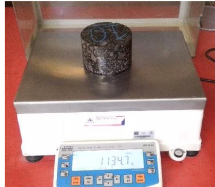
*Imagen 2.23 Espécimen saturado en condición saturada superficialmente seco*
