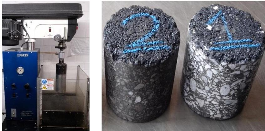
*Imagen 3.9 Extractor de núcleos de concreto asfáltico
