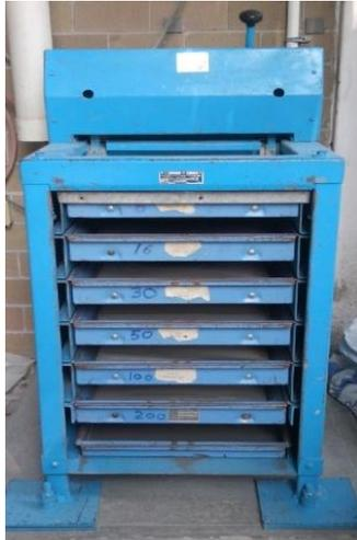
*Imagen 3.3 Cribadora del laboratorio de vías terrestres
