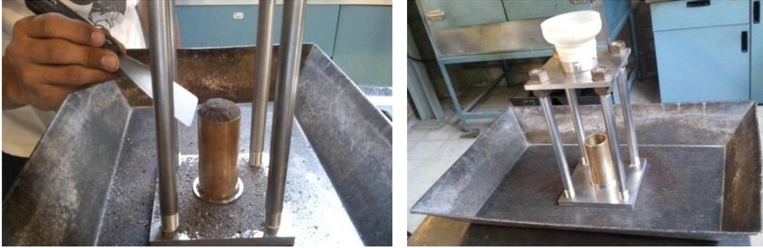
*Imagen 2.3 Prueba de angularidad del agregado fino
