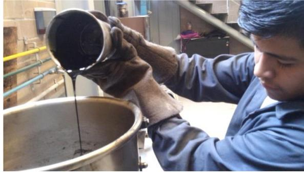
*Imagen 2.17 Colocación del cemento asfáltico
