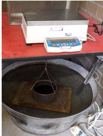
*Imagen 2.20 Mezcla asfáltica sumergida en agua
