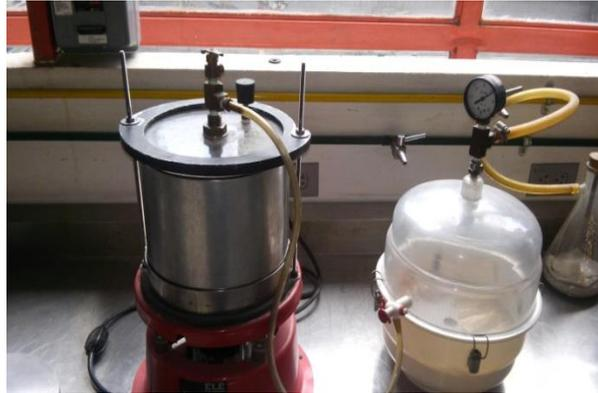
*Imagen 2.19 Presión a la mezcla asfáltica
