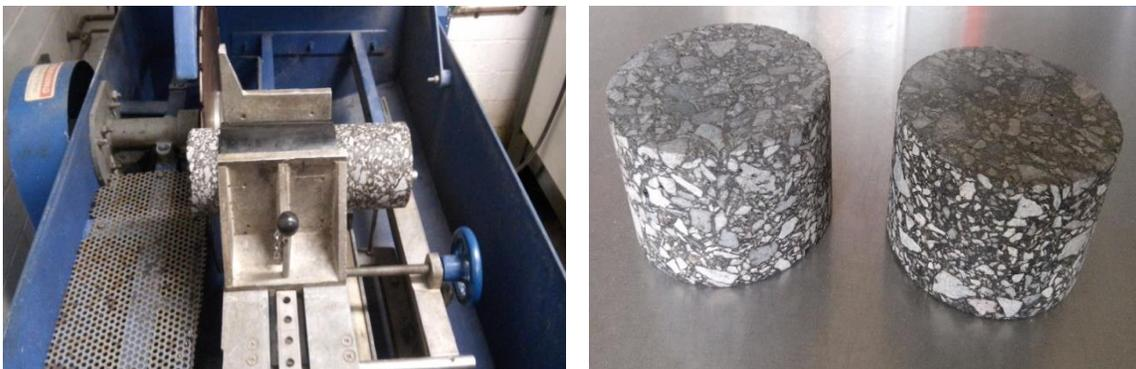
*Imagen 3.10 Cortadora para concreto asfáltico y geometría de especímenes
