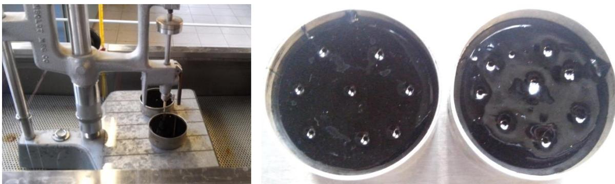
*Imagen 2.13 Prueba de penetración
