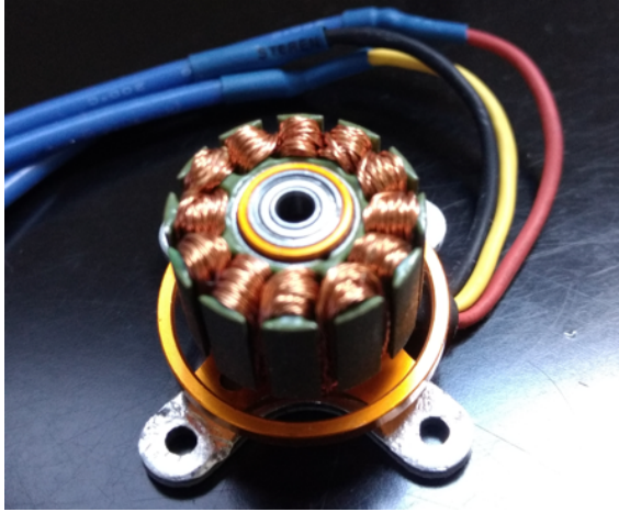
Figura 36: Fotografía del estator del BLDC empleado en este trabajo
