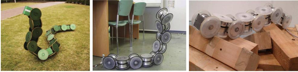
Figura 2.9 Robots serpiente ACM R3 (izquierda), R4 (centro) y R4.1 (derecha).
