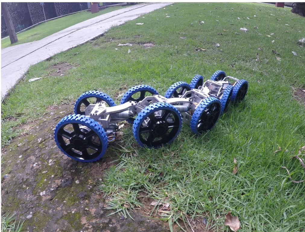
Figura 3.13 Fotografía del robot serpiente construido.
