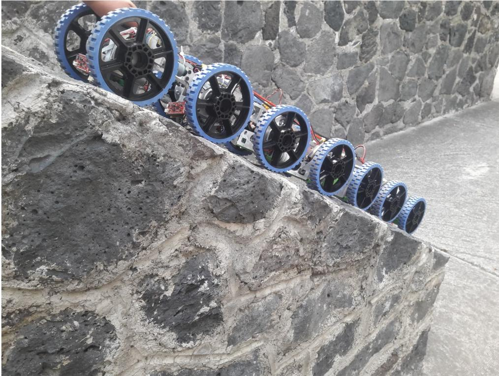
Figura 5.1 Fotografía del robot serpiente sobre una superficie inclinada  $30^\circ$ .
