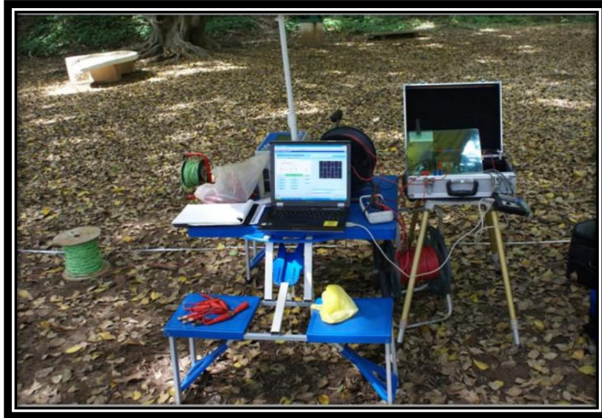
Figura 9. Equipo para la medición de la Resistividad Eléctrica
