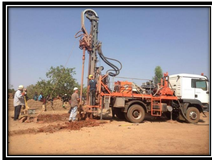
Figura 12. Equipo Rotatorio con control electrónico para hacer los sondeos.
