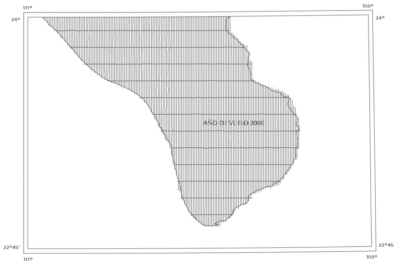
Figura 4.1. Cubrimiento Aerogeofísico de la carta San José del Cabo realizada en enero del 2000, donde se pueden notar las líneas de control a mayor distancia.
