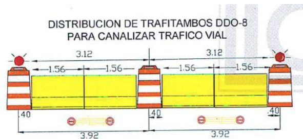
Figura 2.5 Esquema para la colocación de trafitambos.
