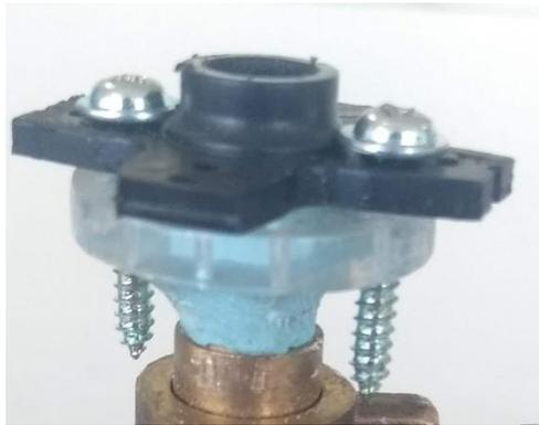
*Fig. 86. Ensamble del cople del servomotor sobre el cople de acrílico.*
