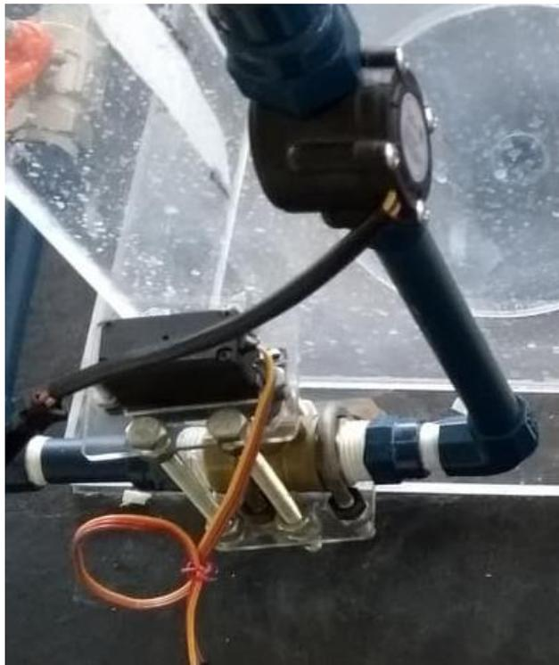
*Fig. 38. Vista de la servoválvula y el sensor de flujo de entrada.*
