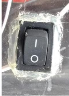
*Fig. 10. Interruptor de seguridad, O representa la posición abierta (no hay paso de corriente eléctrica), por el contrario | representa la posición cerrada (hay paso de corriente).*
