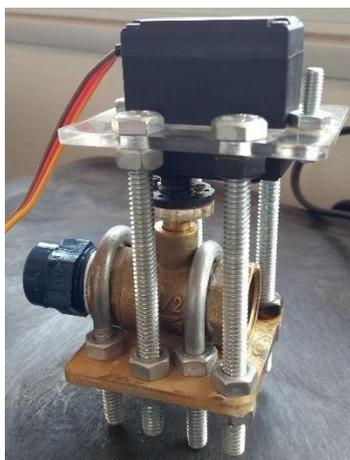
Fig. 77. Para desarmar la servoválvula, retire todas las tuercas y tornillos.
