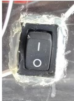
*Fig. 40. Interruptor de seguridad acoplado al gabinete.*
