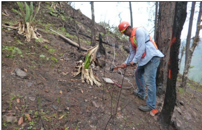
Fotografía 3.5. Colocación de geófono para el tendido TSC4-01
