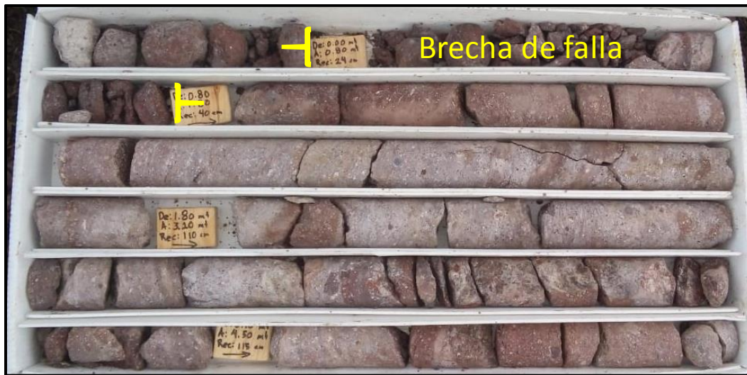
Fotografía 4.10. Muestra de roca obtenida en el sondeo C4-S-06. Es notable que en los primeros tramos la roca está muy fracturada y el material más fino fue lavado durante la perforación
