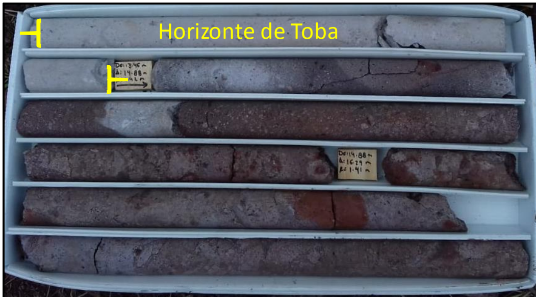
Fotografía 4.8. Muestra del horizonte de toba registrado en el sondeo C4-S-05. Se aprecia que la roca es sana y consistente; contrario a su aspecto en superficie.
