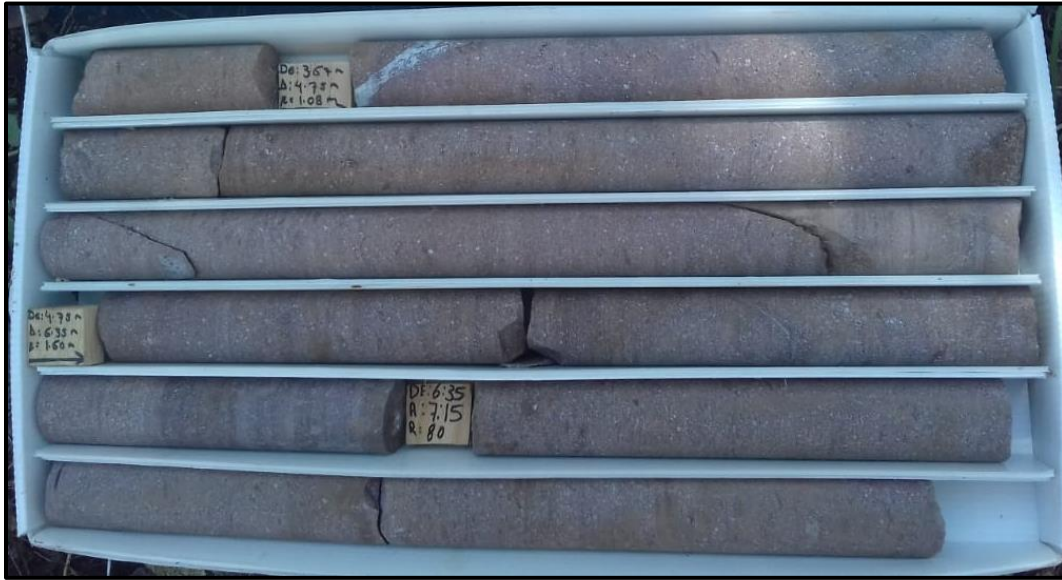
Fotografía 4.3. Muestra de la unidad Tr-bv obtenida de un sondeo exploratorio. La roca se muestra sana y con fracturas ocasionales, algunas de ellas con relleno de sílice
