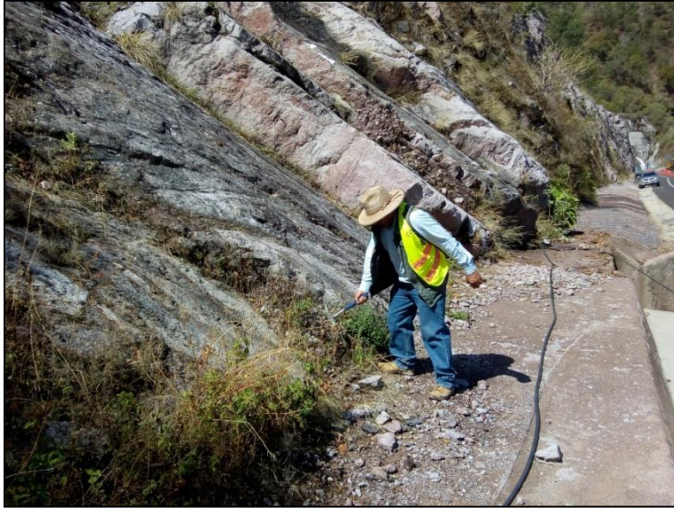
Fotografía 3.1. Muestreo del macizo rocoso en cara del talud
