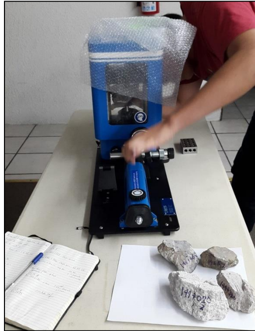
Fotografía 3.4. Equipo utilizado para ensayos de carga puntual
