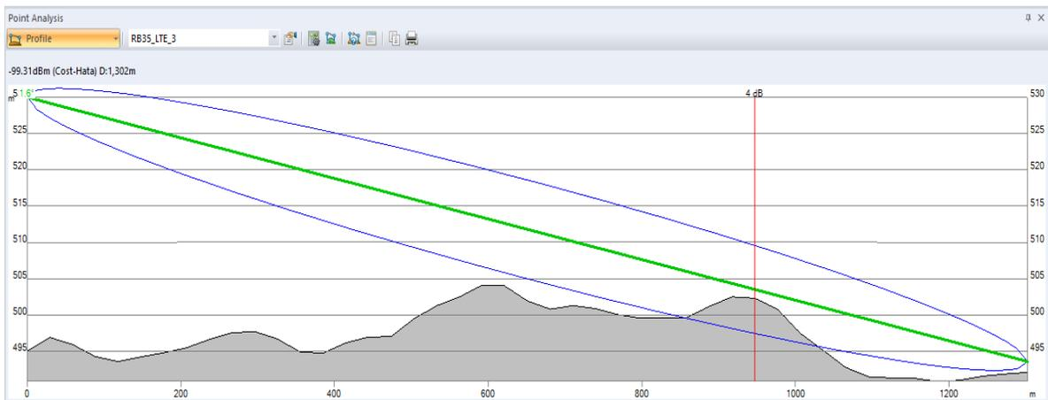
Figura 84. En esta figura se puede observar que el sensor número tres presenta línea de vista con la radiobase 35 transmisor (3). Pero la zona de fresnel se ve afectada por la geografía presente en esta ciudad.
