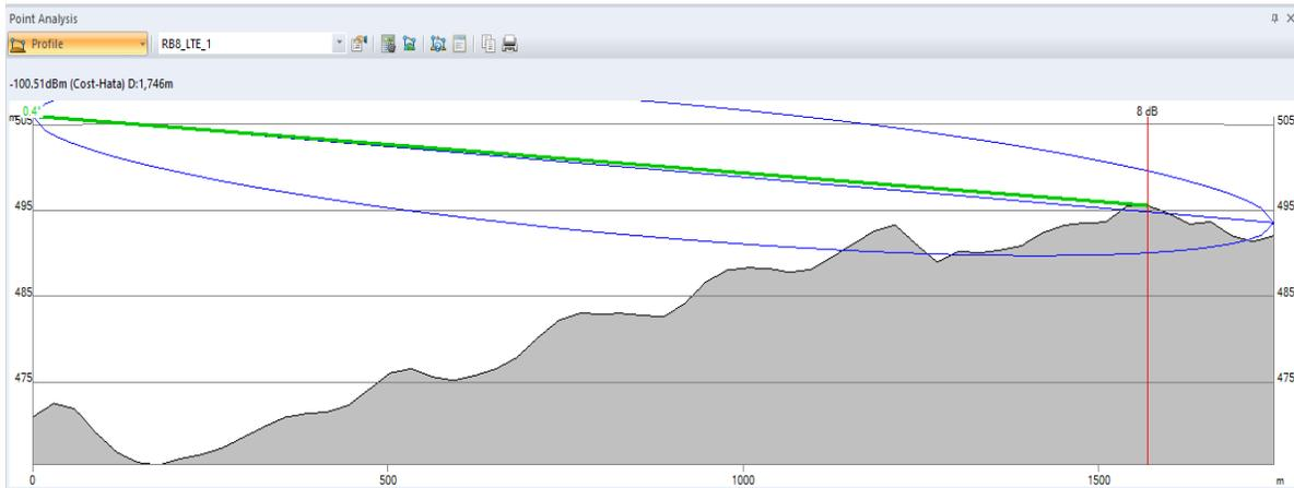
Figura 85. En esta figura se puede observar que el sensor número tres no presenta línea de vista con la radiobase 8 transmisor (1) al igual que la zona de fresnel se ve afectada por la geografía presente en esta ciudad.
