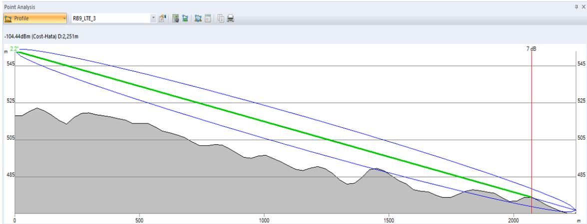
Figura 92. En esta figura se puede observar que el sensor número cuatro no presenta línea de vista con la radiobase 9 transmisor (3).
