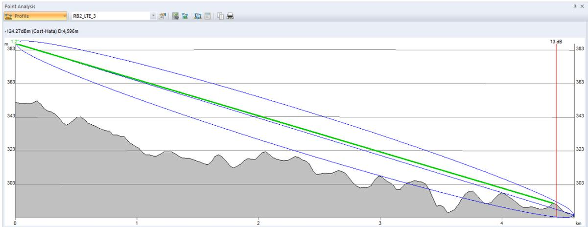
Figura 72. En esta figura se puede observar que el sensor no cuenta con línea de vista con el transmisor debido a la geografía presente en esta ciudad.
