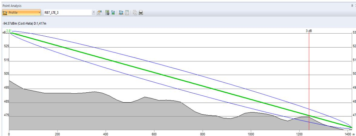
Figura 91. En esta figura se puede observar que el sensor número cuatro presenta línea de vista con la radiobase 7 transmisor (3). Pero se debe de considerar que la zona de fresnel se ve afectada por la geografía de la zona.
