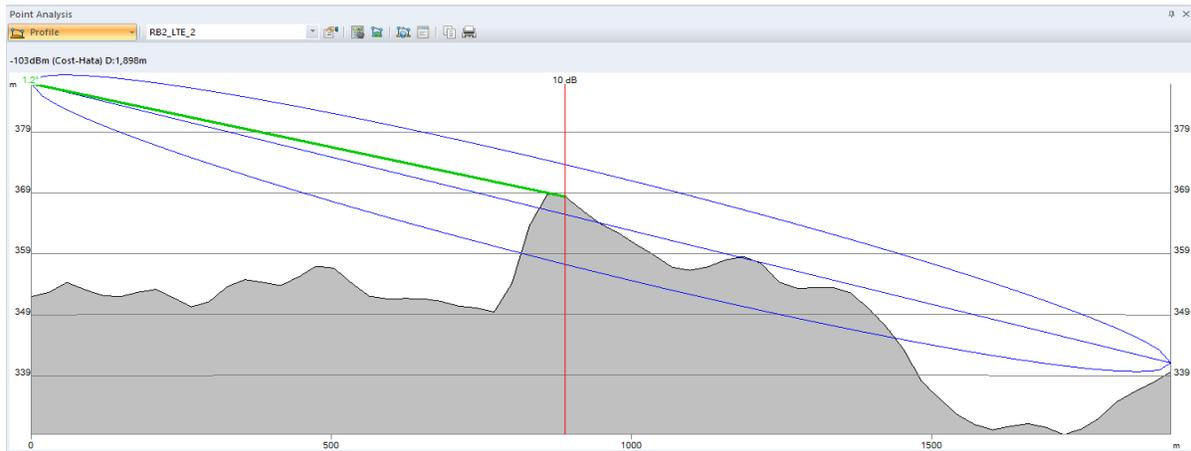
Figura 78. En esta figura se puede observar que el sensor número dos no presenta línea de vista con la radiobase 2 transmisor (2).
