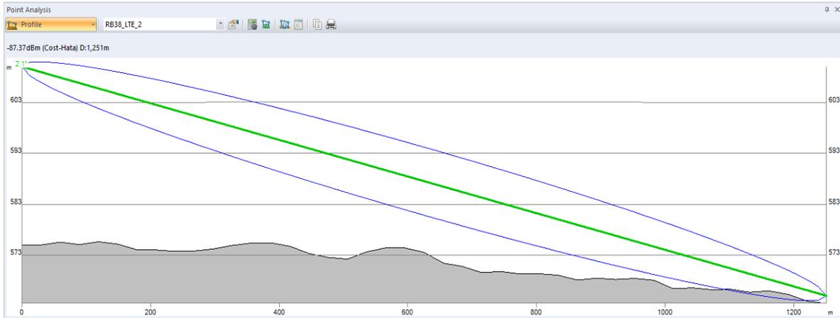
Figura 103. En esta figura se puede observar que el sensor número seis presenta línea de vista con la radiobase 38 transmisor (2). Aunque también se observa que se ve afectada nuestra zona de fresnel por la geografía de esta ciudad.
