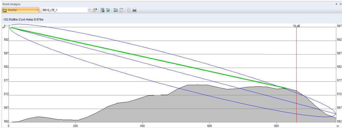
Figura 104. En esta figura se puede observar que el sensor número seis no presenta línea de vista con la radiobase 16 transmisor (1).
