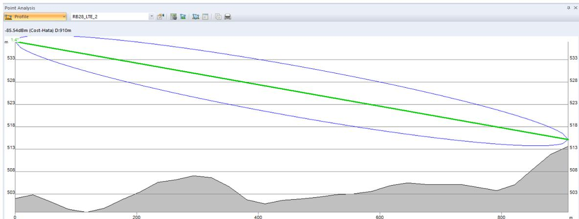
Figura 99. En esta figura se puede observar que el sensor número cinco presenta línea de vista con la radiobase 28 transmisor (2).
