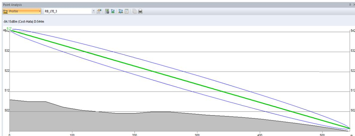
Figura 82. En esta figura se puede que el sensor número tres presenta línea de vista con la radiobase 0 transmisor (3).
