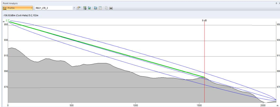
Figura 108. En esta figura se puede observar que el sensor número siete no presenta línea de vista con la radiobase 21 transmisor (3).
