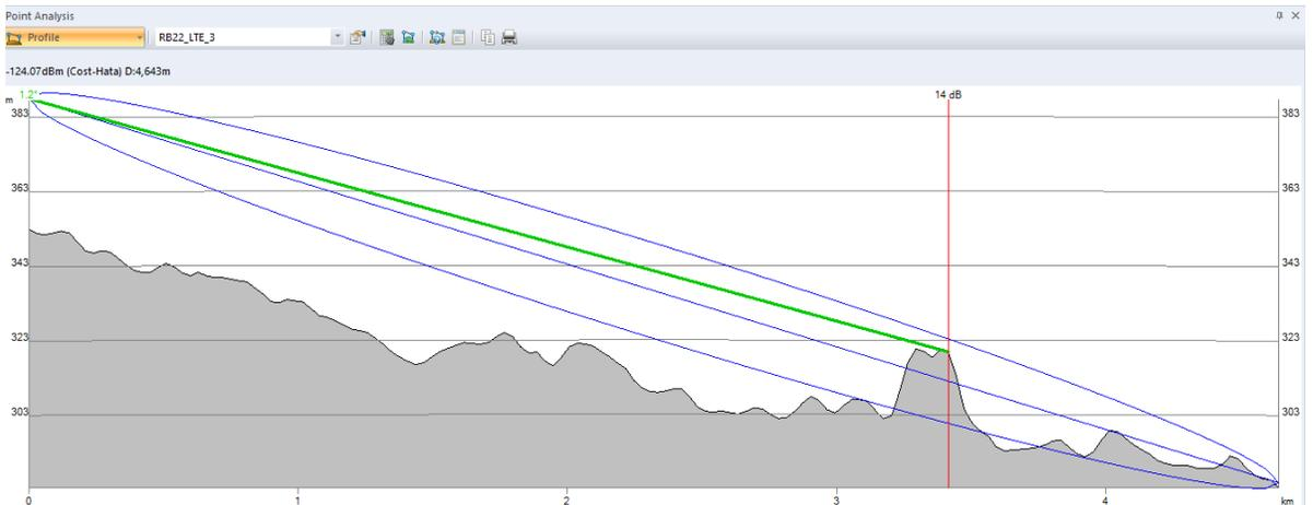
Figura 73. En esta figura se puede observar que el sensor no cuenta con línea de vista con el transmisor debido a la geografía presente en esta ciudad.
