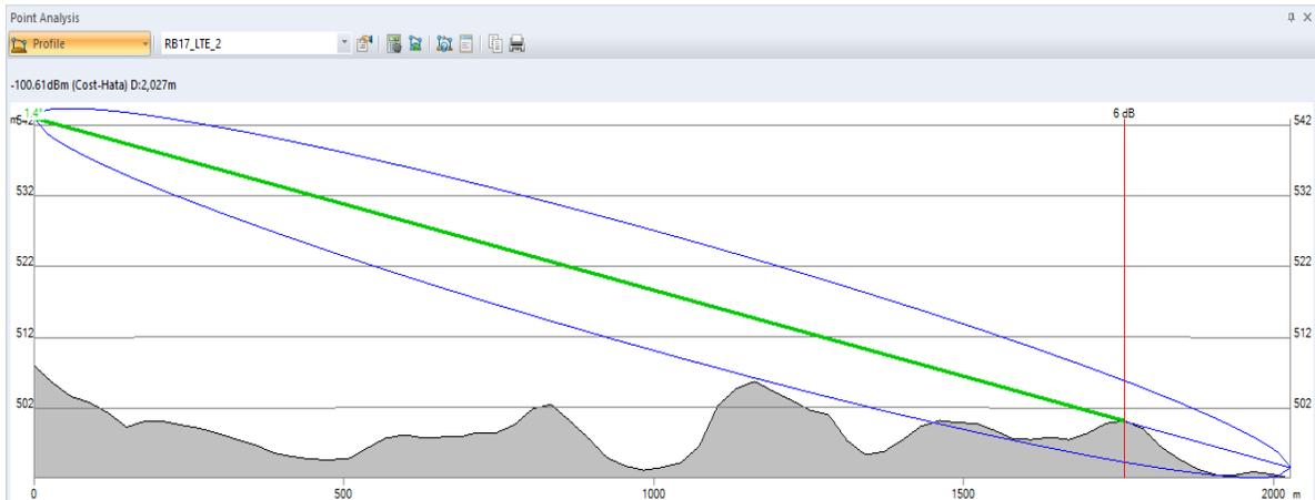
Figura 86. En esta figura se puede observar que el sensor número tres no presenta línea de vista con la radiobase 17 transmisor (2) al igual que la zona de fresnel se ve afectada por la geografía presente en esta ciudad.
