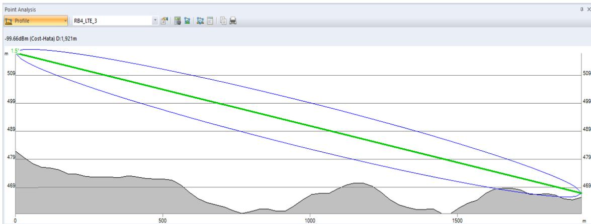
Figura 93. En esta figura se puede observar que el sensor número cuatro presenta línea de vista con la radiobase 4 transmisor (3).
