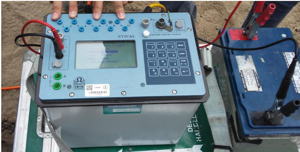
Figura 19 Resistivmetro SYSCAL Pro Switch 48 de Iris Instrument utilizado para la tomografía de resistividad eléctrica de los sedimentos en la Cuenca Sandia.
