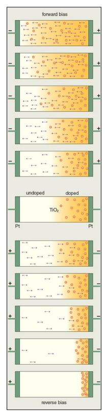
Figura 5: Comportamiento de los portadores de carga en un memristor de dióxido de titanio de HP [6].
