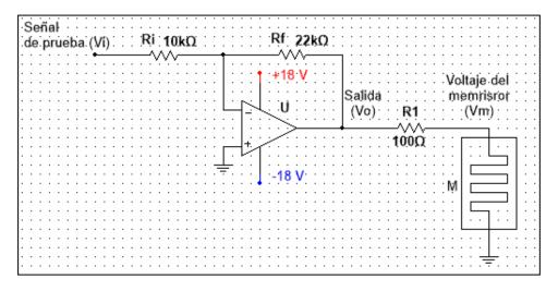
Figura 18: Diagrama equivalente de las conexiones en una prueba en corriente alterna.
