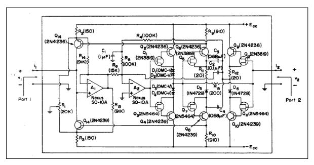
Figura 1: Circuito activo de Leon Chua para emular memristores en 1971, antes de encontrar un elemento pasivo que tuviese comportamiento memristivo. [1]
