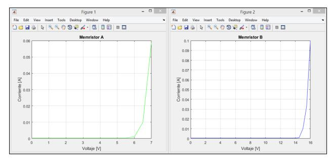
Figura 16: Curvas de encendido de dos memristores tipo Marconi. ( $V_{THA} \cong 6.8$  [V] y  $V_{THB} \cong 15.6$  [V]).
