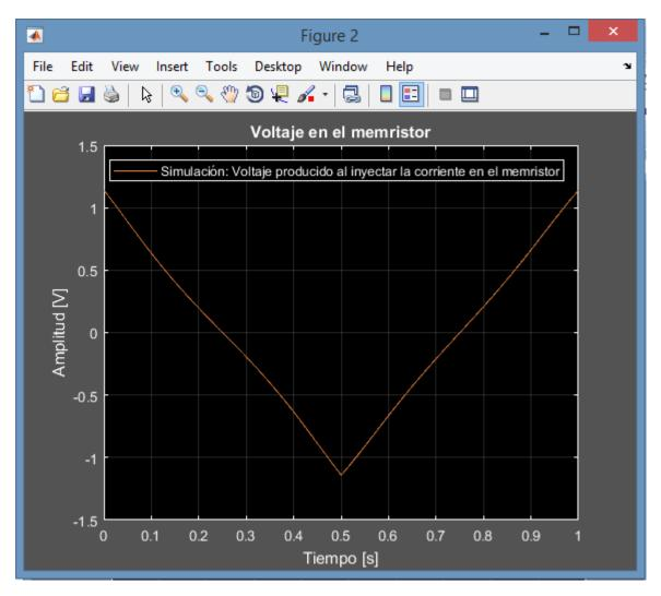
Figura 79: Voltaje en el memristor.
