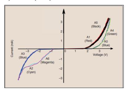
Figura 11: Curva de histéresis de voltaje contra corriente en un memristor tipo bigote de gato [2].
