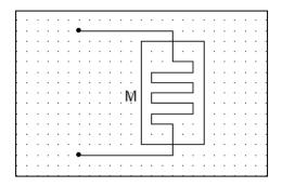
Figura 13: Símbolo eléctrico de un memristor.
