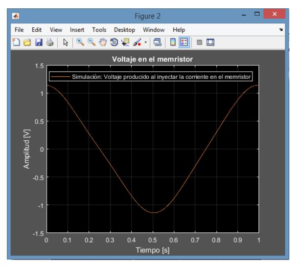
Figura 73: Voltaje en el memristor.
