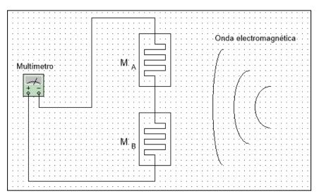
Figura 39: Prueba de cohesores en serie.
