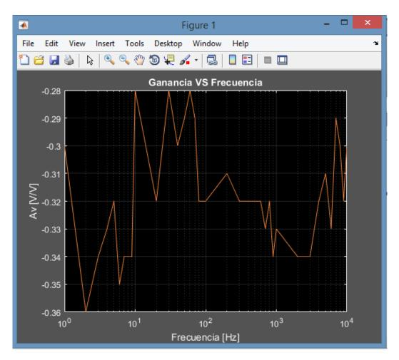
Figura 58: Configuración inversora: Ganancia contra frecuencia.
