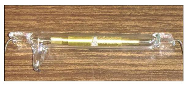
Figura 47: Memristor de tipo Marconi en posición horizontal.
