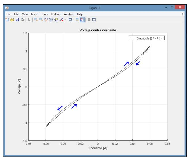
Figura 30: Trayectoria que describe la curva de histéresis V-I en un memristor tipo Marconi.
