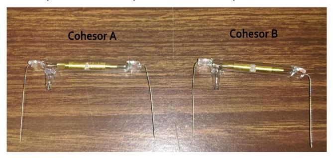
Figura 12: Cohesores tipo Marconi utilizados para las pruebas realizadas. El cohesor B tiene mayor cantidad de limaduras de metal que el cohesor A.
