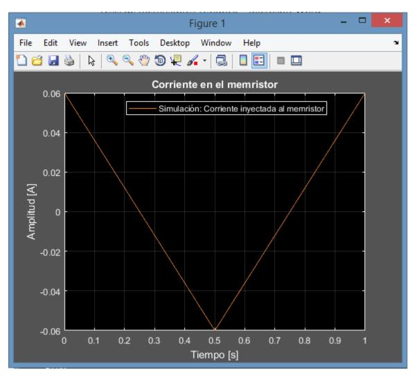
Figura 78: Corriente inyectada al memristor en la simulación.
