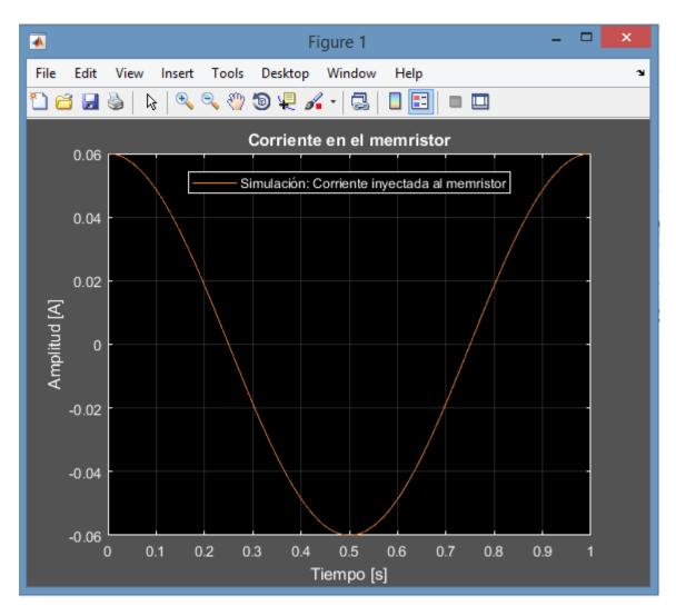
Figura 72: Corriente inyectada al memristor en la simulación.
