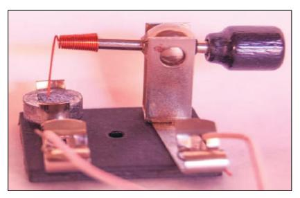
Figura 9: Cohesor tipo bigote de gato "cat's wisker" [2].
