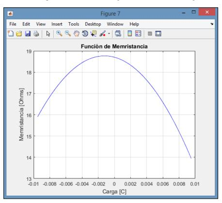
Figura 28: Curva de memristancia M(q) del memristor A.
