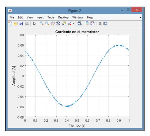
Figura 22: Corriente en el memristor en un ciclo.
