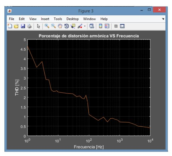
Figura 54: Configuración inversora: %THD contra frecuencia.
