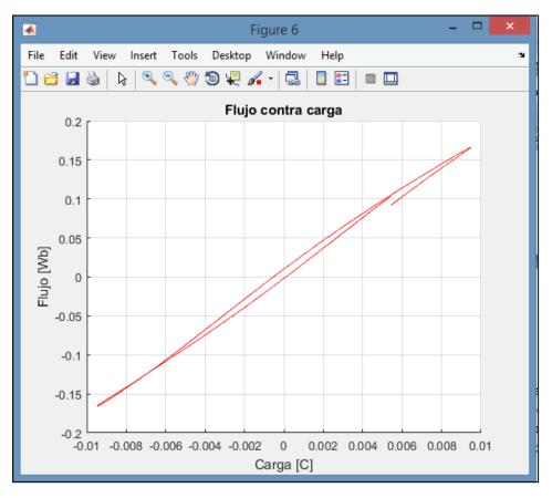
Figura 26: Flujo contra carga en el memristor A.
