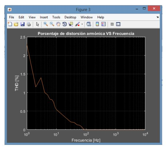
Figura 60: Configuración inversora: %THD contra frecuencia.
