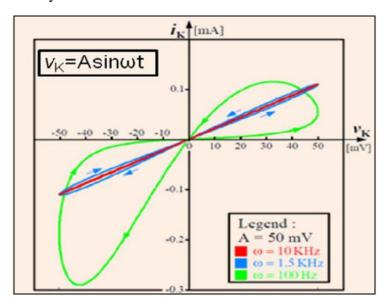
Figura 6: Comportamiento experimental de un memristor de potasio [3].
