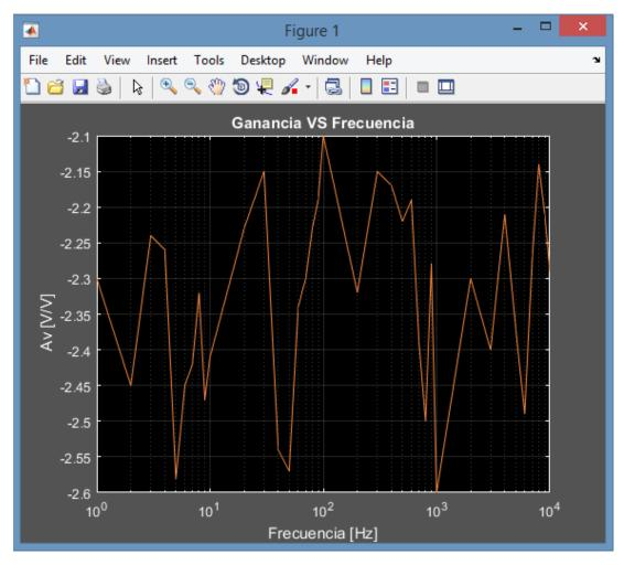
Figura 52: Configuración inversora: Ganancia contra frecuencia.
