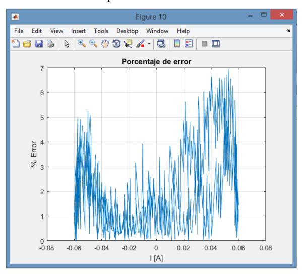
Figura 85: Porcentaje de error entre las curvas de histéresis experimental y teórica ( $\overline{E}\cong 2.8\%$ ).
