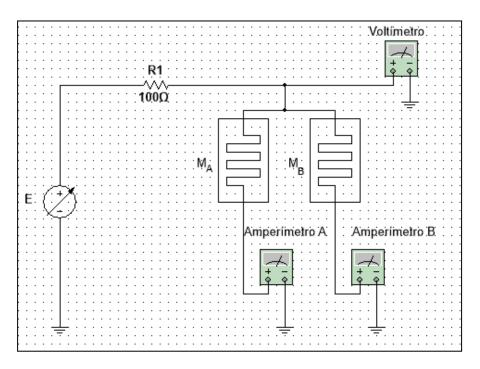
Figura 46: Prueba en corriente directa de memristancias en paralelo.
