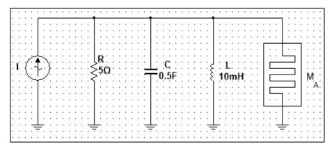
Figura 67: Circuito MLC equivalente de Norton.
