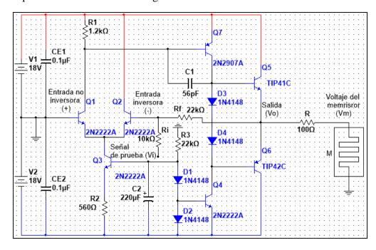
Figura 17: Amplificador operacional construido a partir de elementos discretos.
