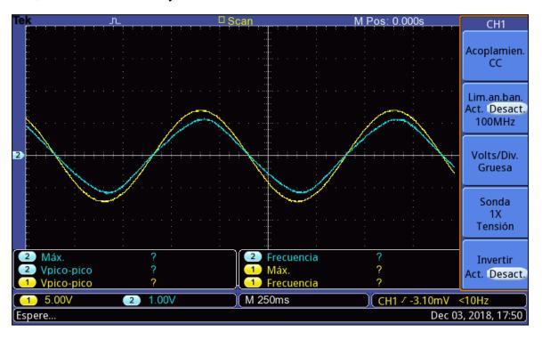
Figura 20: Señal de prueba sinusoidal de 14 Vpp a 1 Hz.
