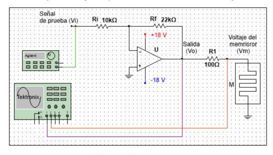
Figura 19: Prueba de corriente alterna en un memristor tipo Marconi.
