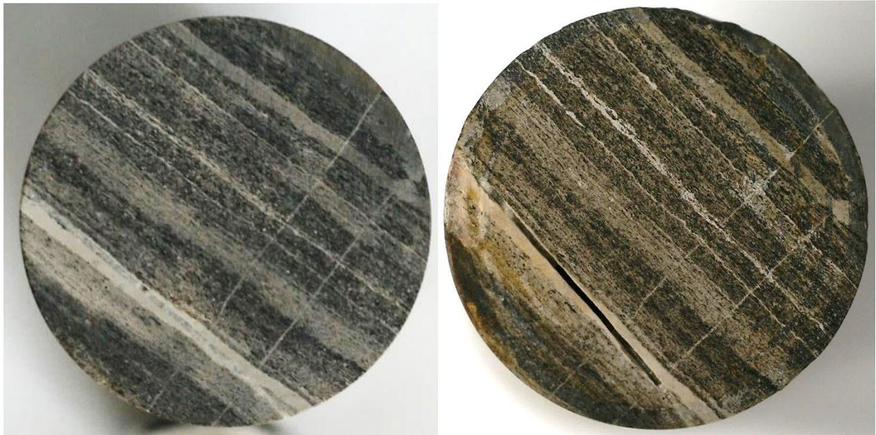
*Figura 4.25 Estimulación de la cara de entrada del tapón de formación KTI con Ácido A al 1 %w, 45 °C y 10 ml/h*
