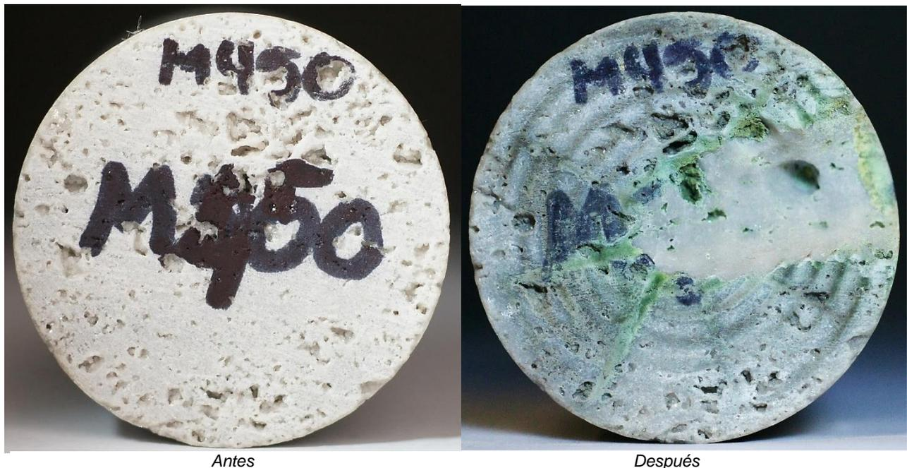
Figura 4.17 Estimulación con HCl en la cara de entrada
