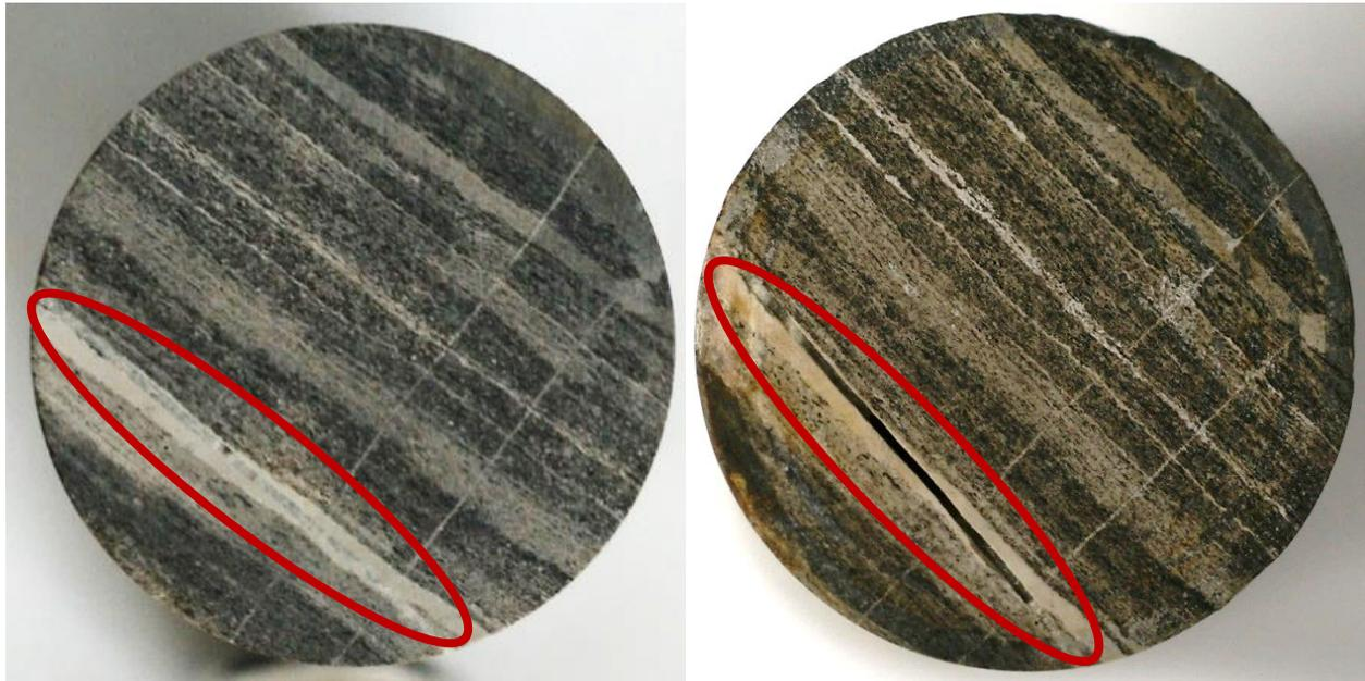
*Figura 5.14 Estimulación en la cara de entrada del tapón de la formación KTI con Ácido A al 1 %w a 45 °C y 10 ml/h*
