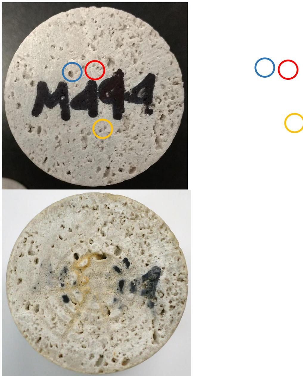
Figura 5.12 Estimulación con Ácido A al 1 %w en la cara de entrada del tapón de dolomita del Experimento II a 45 °C y 10 ml/h
