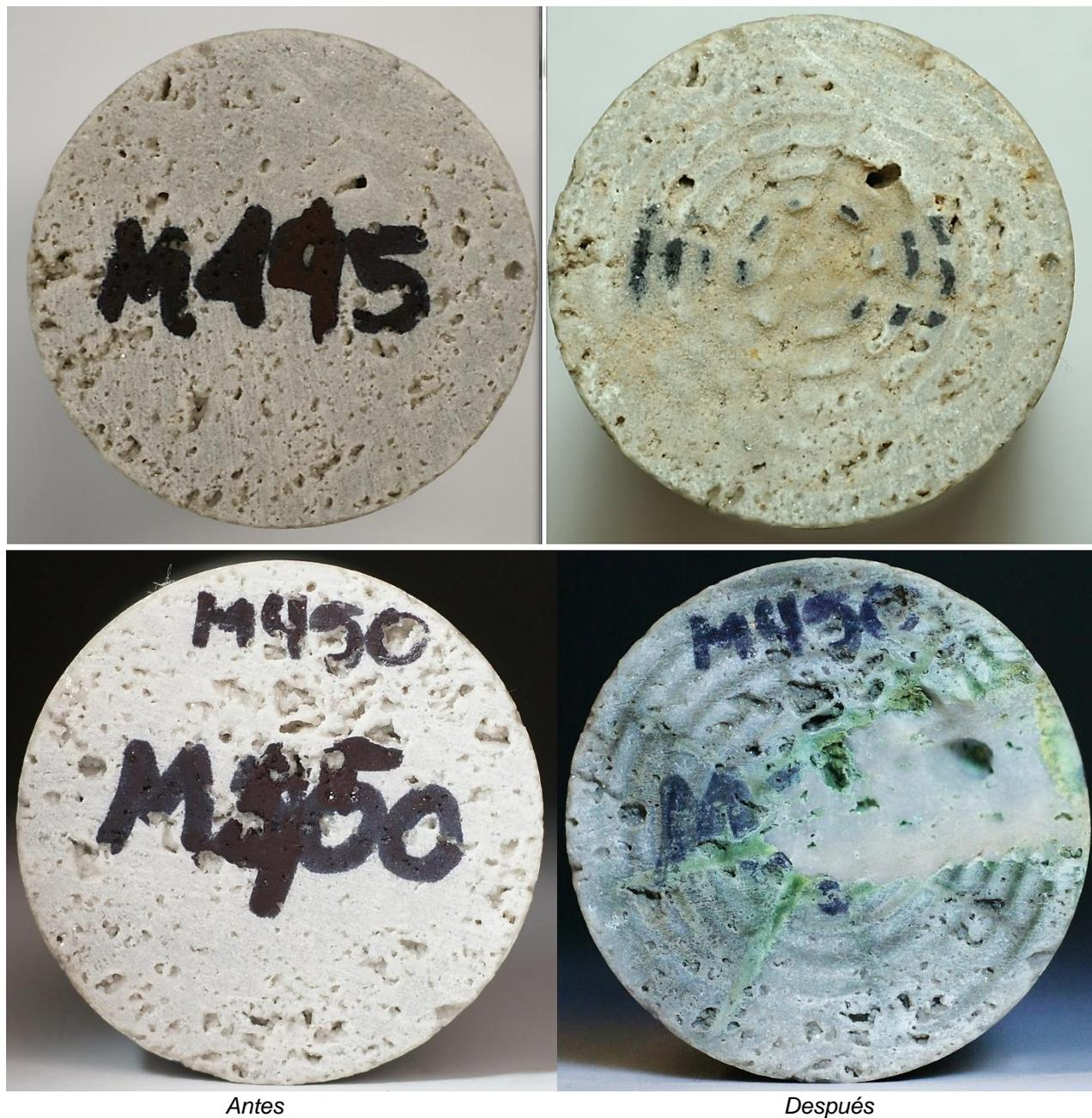
Figura 5.10 Comparación de estimulación de matriz entre disolución de Ácido A (superior) y disolución de HCl (inferior) en la cara de entrada del tapón
