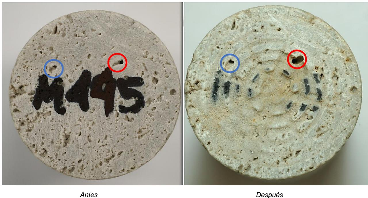
Figura 5.5 Estimulación con Ácido A en la cara de entrada del tapón de dolomita a 45 °C y 10 ml/h
