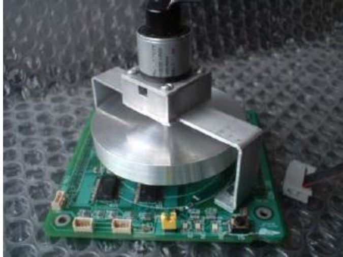
Figura 1.6 Subsistema de Estabilización.
