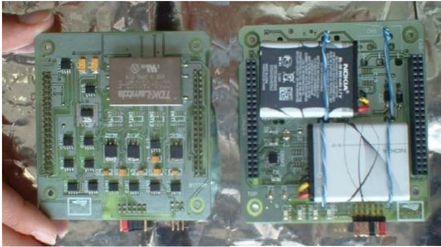
Figura 1.5 Subsistema de Potencia.
