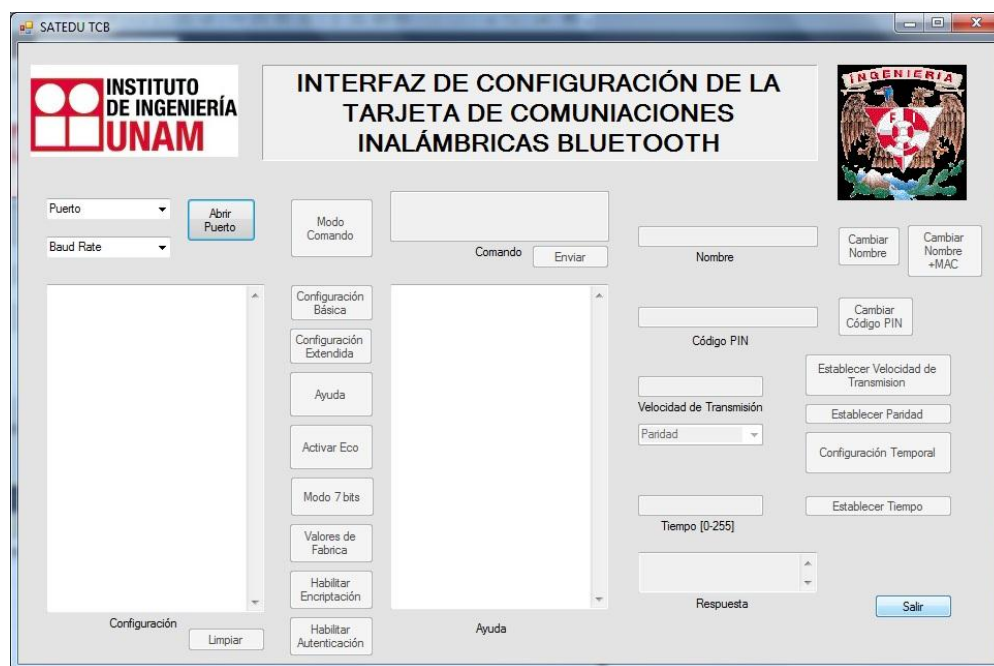
Figura 5.4 Interfaz de configuración de la Tarjeta de Comunicaciones Inalámbricas Bluetooth.
