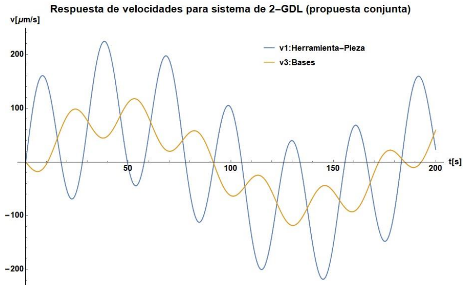
Figura 57: Respuesta de velocidades para el sistema de 2-GDL en 200 [s].
