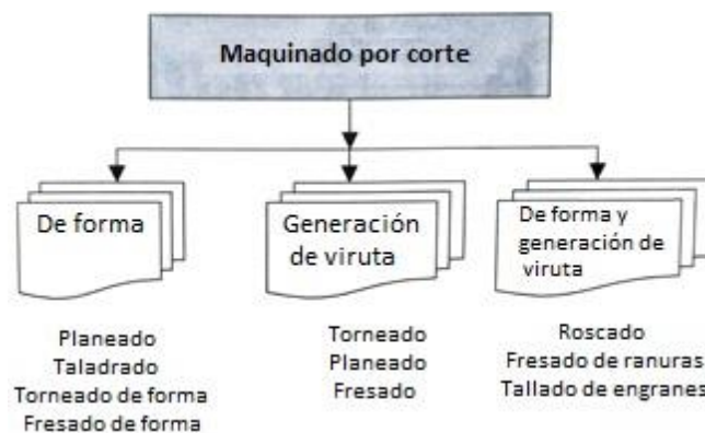
Figura 4: Maquinado por corte [3].
