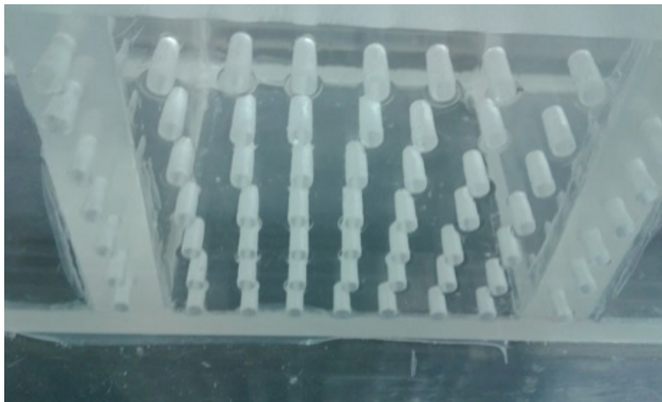
Figura 3-8: Barrenos en la cavidad central y los muros laterales
