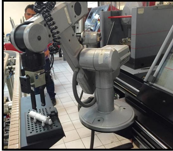
Figura 32. Robot Scorbot de 5 GDL, definido como Robot #2 para efectos de la simulación (Maq.4), cuya disposición tiene como finalidad que después de que la materia prima (tochos cilindrados) se encuentren en la banda transportadora mediante un template con pallet, el robot la lleve hacia la posición del centro de maquinado de torno para ejecución del proceso de manufactura, y viceversa.
