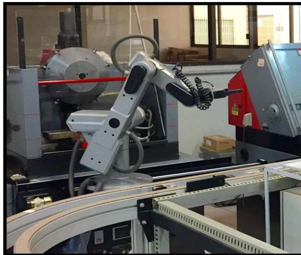
Figura 33. Robot Scorbot de 5 GDL, definido como Robot #3 para efectos de la simulación (Maq.2), cuya disposición tiene como finalidad que después de que la materia prima (barras) se encuentren en la banda transportadora mediante un template con pallet, el robot la lleve hacia la posición del centro de maquinado de fresa para ejecución del proceso de manufactura, y viceversa.
