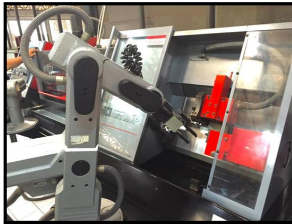
Figura 34. Centro de maquinado CNC tipo EMC TURN 120 para elaboración del proceso de torneado, definido como entidad 1 para efectos de la simulación, cuya disposición tiene como finalidad que después de que la materia prima (tochos cilindrados) se encuentren en la banda transportadora mediante un template con pallet, el robot sea quien le suministre de materia prima para la ejecución de las tareas programadas previamente.
