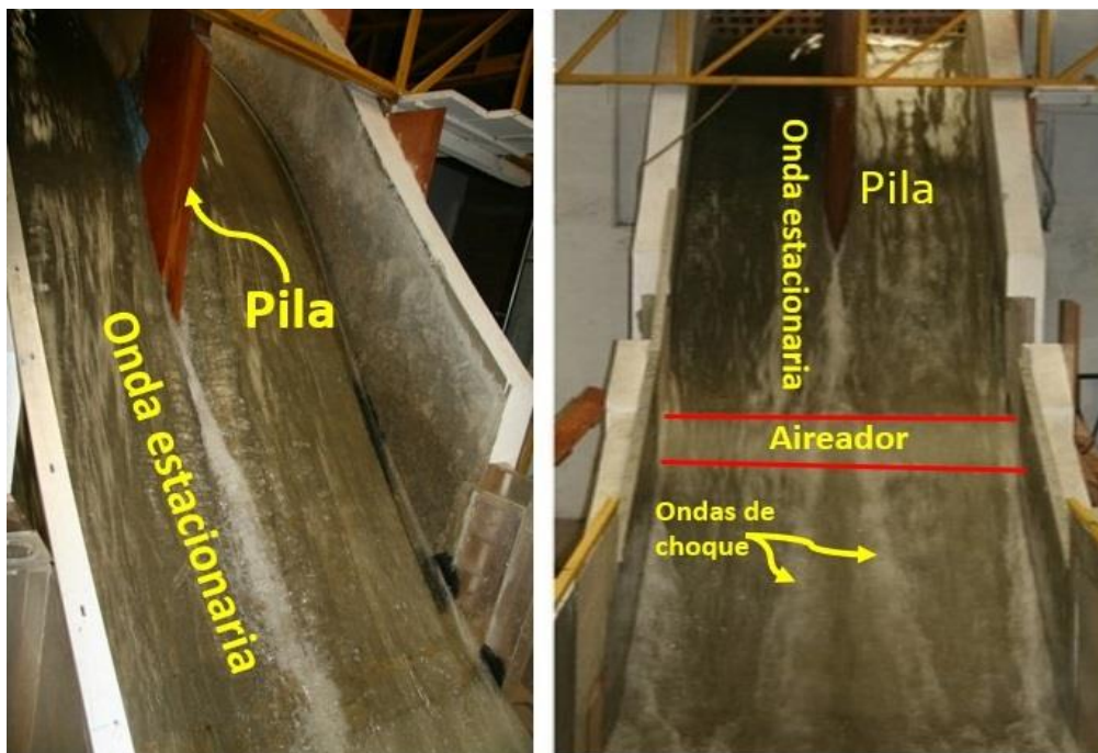
Figura 3.29. Onda estacionaria y de choque en la rápida del vertedor
