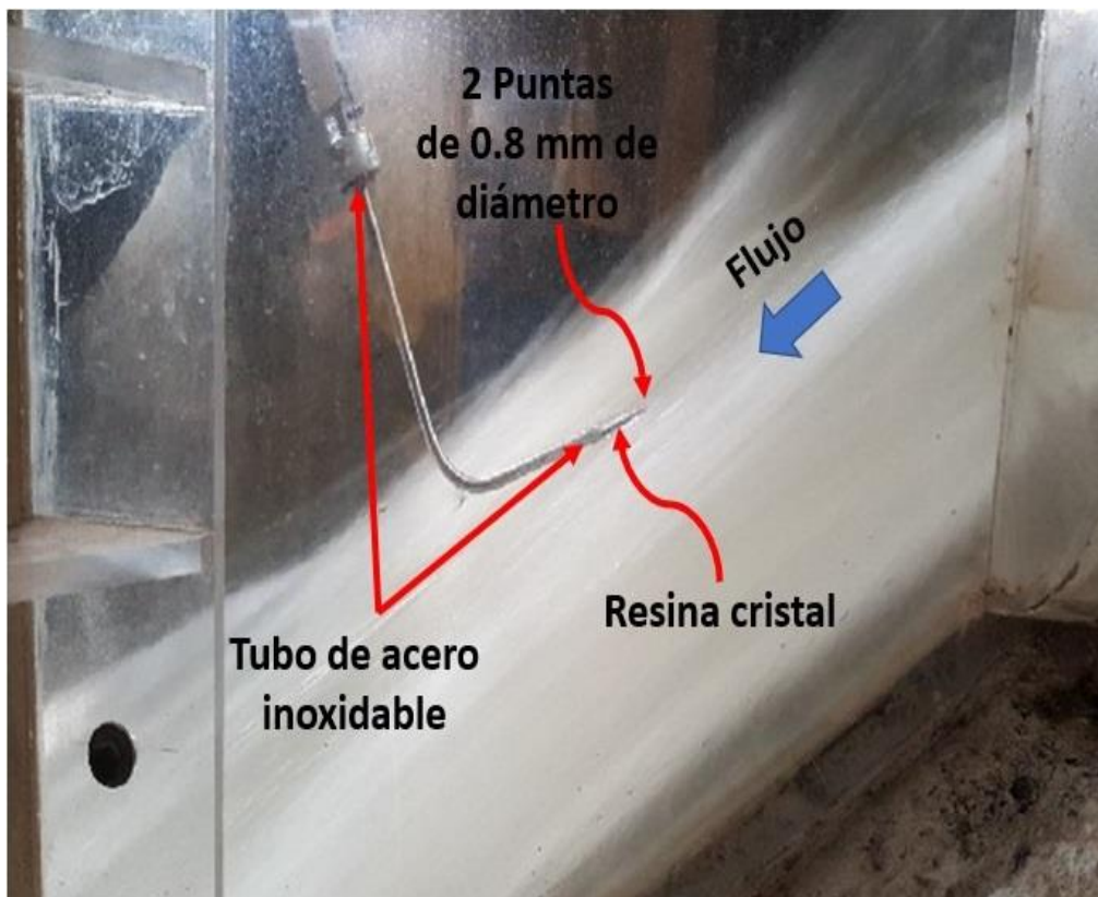
Figura 4.9. Partes de la sonda de conductividad de doble punta
