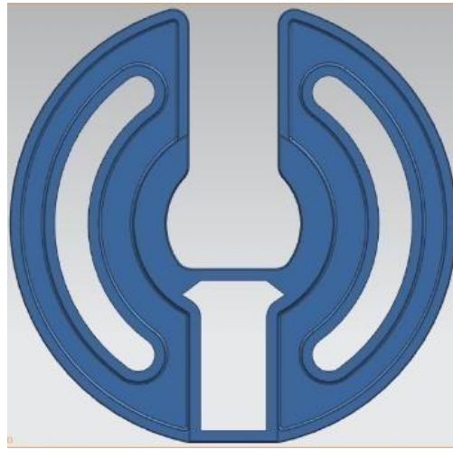
Figura 62 Zona gruesa eliminada por posibles defectos.
