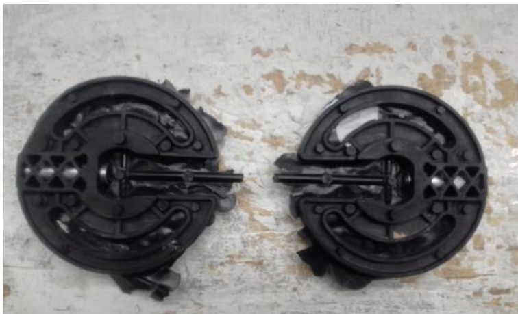
Figura 123 Pieza con excedentes de material (rebabas).
