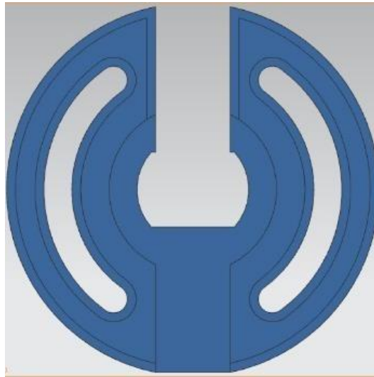
Figura 48 Haciendo uso de costillas para disminuir espesor de pieza y rigidizar al nodo.
