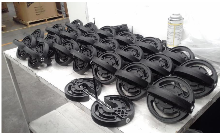
Figura 127 Conectores ensamblados (Nodos).
