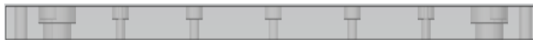
Figura 94 Vista lateral de la placa de respaldo interna considerando el alojamiento de los expulsores
