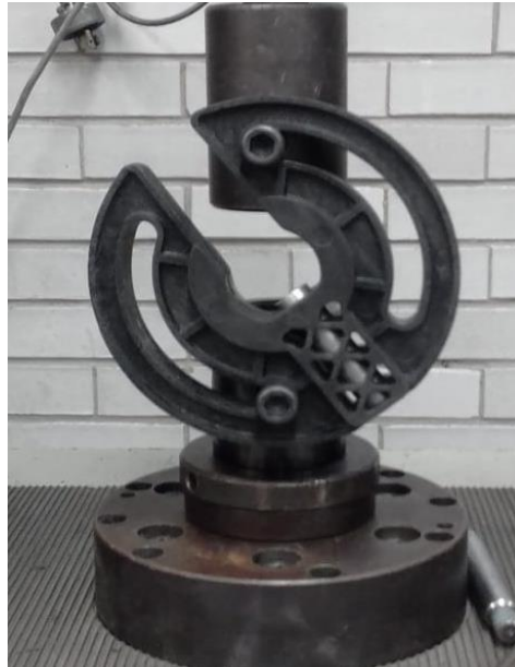
Figura 129 Análisis a tracción en la zona mixta.
