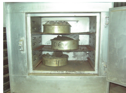
Figura 4.15 Secado de material en el horno
