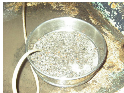
Figura 4.17 Lavado de material que pasa la malla 4
