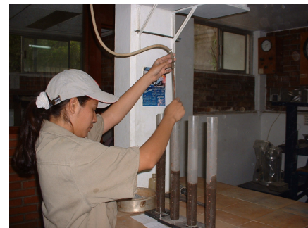
Figura 4.26 Vertido de solución en probetas con material
