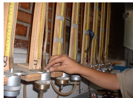
Figura 4.29 Colocación de permeámetros
