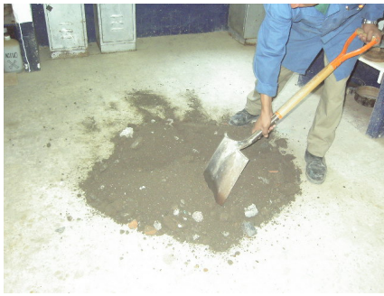
Figura 4.8 Cuarteo de material en laboratorio
