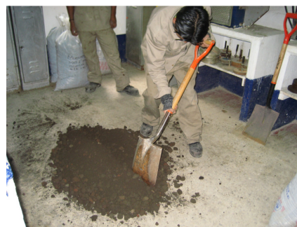
Figura 4.40 Cuarteo de material y fabricación de mezclas
