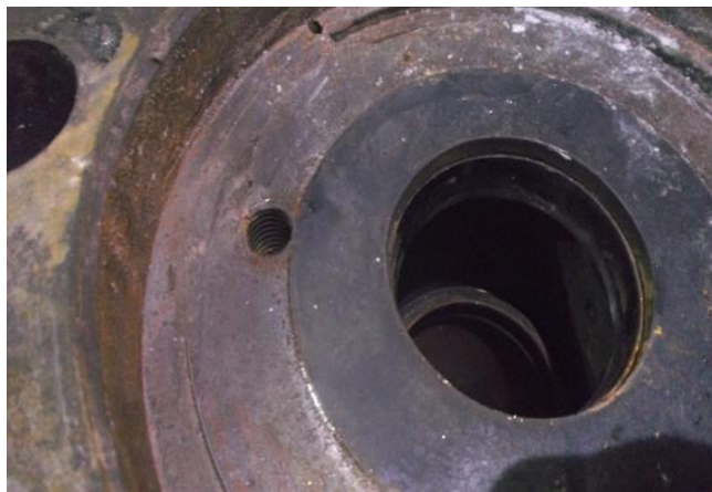
Figura 23. Desgaste de la nariz de la perforadora del jumbo anclador # 10 (23 abr 2016)
