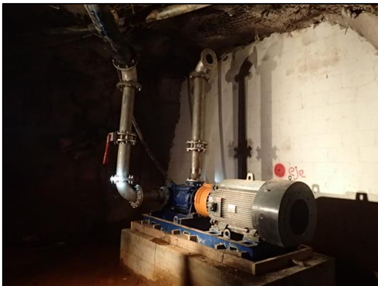
Figuras 104 y 105. Ensamble de accesorios para cierre con la tubería de fibra de vidrio en nivel 790
