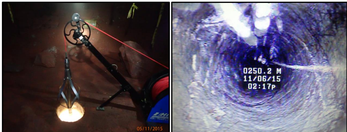
Figuras 39 y 40. Grabación interna del barreno piloto
