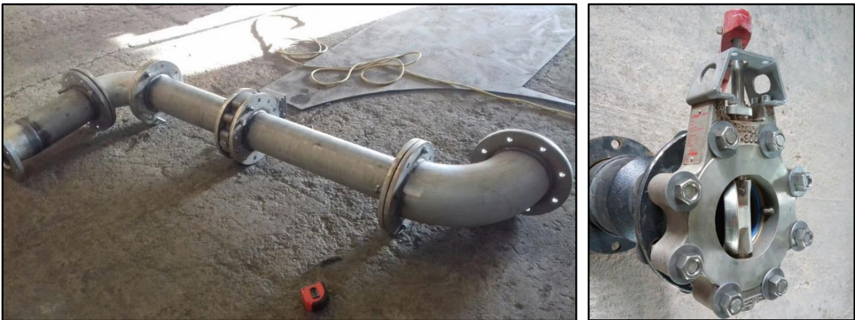
Figuras 101 y 102. Fabricación de accesorios en acero inoxidable 316L
