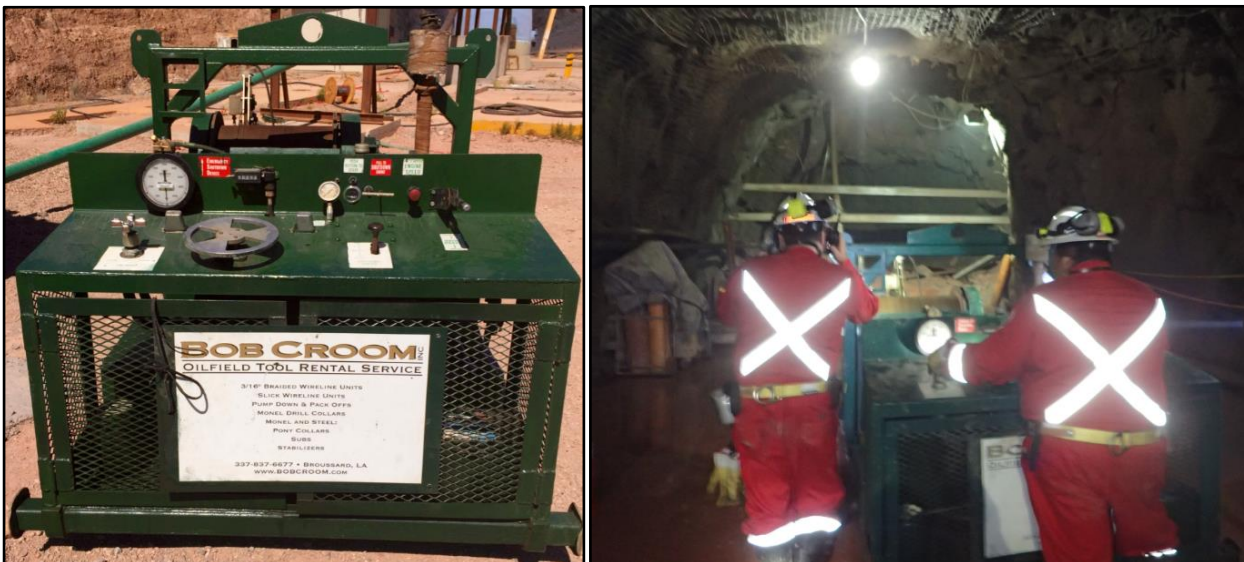
Figuras 60 y 61. Malacate diésel utilizado en nivel 1160 para jalar la tubería de superficie
