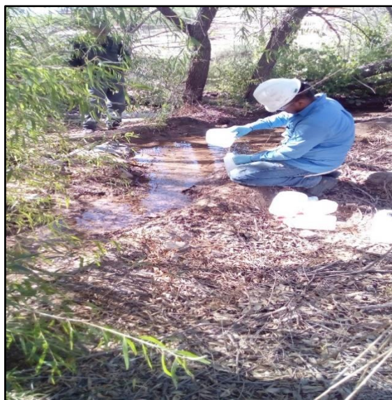
Figuras 114 y 115. Muestreo de la descarga del último represo
