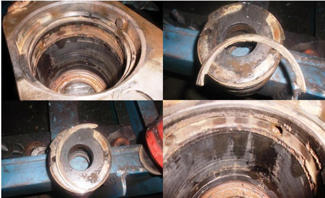
Figura 21. Desgaste de la nariz de la perforadora del jumbo anclador # 05 (10 feb 2016)
