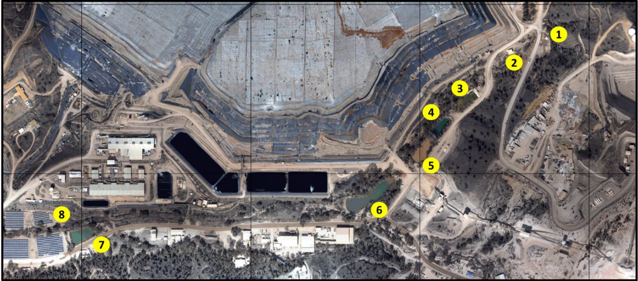
Figura 26. Secuencia en el sistema de decantación del agua de bombeo
