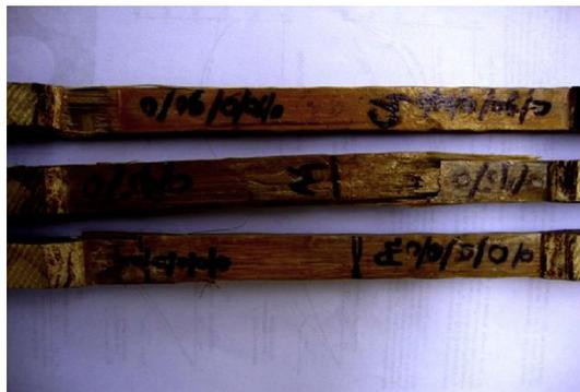
**FIGURA 10.9** Ejemplo de probetas de bambú-resina, sobre las que se realizó un ensayo de tracción, (Verma *et al.*, 2012)
