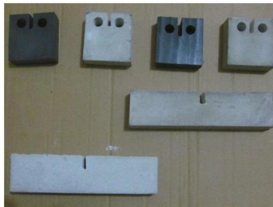
**FIGURA 1.15** Probetas cerámicas y poliméricas
