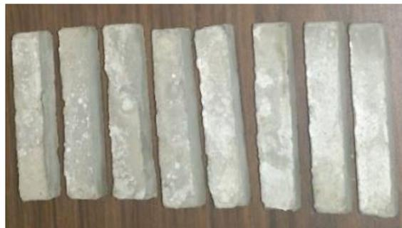
**FIGURA 1.12** Probetas cerámicas
