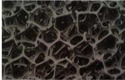
**FIGURA 4.3** Espuma de poros abiertos (Gibson et al., 1997)
