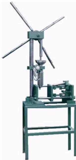
FIGURA 7.1 Inyectora manual (Groover, 2007)
