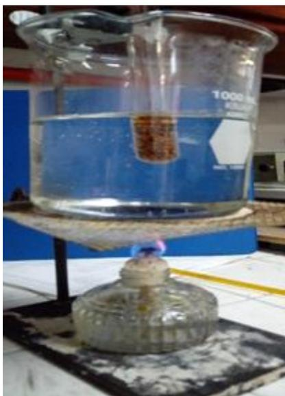
**FIGURA 5.4** Baño termostático para la fabricación de baquelita
