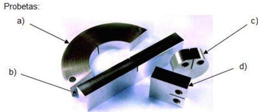
**FIGURA 3.5** Diferentes tipos de probetas de la Norma ASTM E399. a) Probeta en forma de arco. b) Probeta a flexión. c) Probeta en forma de disco. d) Probeta compacta. (ASTM E399, 1997)
