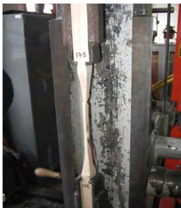
**FIGURA 10.10** Probeta de madera paralela al grano a la que se le realizara un ensayo de tracción. (Merchán, 2012)
