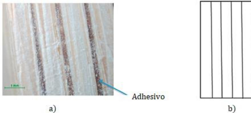
**FIGURA 1.22** a) Unión de las láminas de bambú con la resina epóxica en la probeta para ensayo de tracción. b) Colocación subsecuente de las probetas en las placas de vidrio. (Verma et al., 2013)
