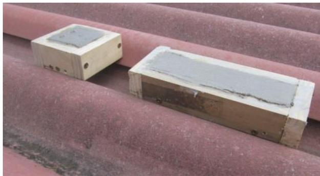
**FIGURA 1.13** Probetas cerámicas
