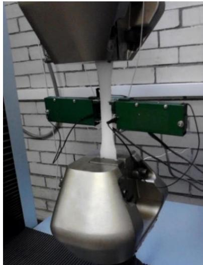
**FIGURA 6.4** Extensómetro colocado en la región estrecha de la probeta (Hernández, 2015)
