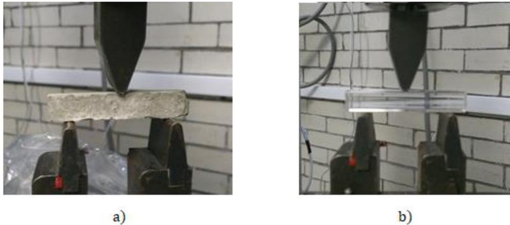
**FIGURA 2.2** Las probetas deben colocarse con una distancia entre puntos de 50 mm y hacer ajuste con la perilla de la máquina universal para evitar la aplicación de precargas a) probeta de cemento gris. b) probeta de acrílico
