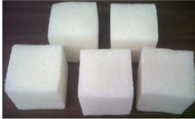
**FIGURA 1.19** Probetas terminadas, listas para ser sometidas a compresión
