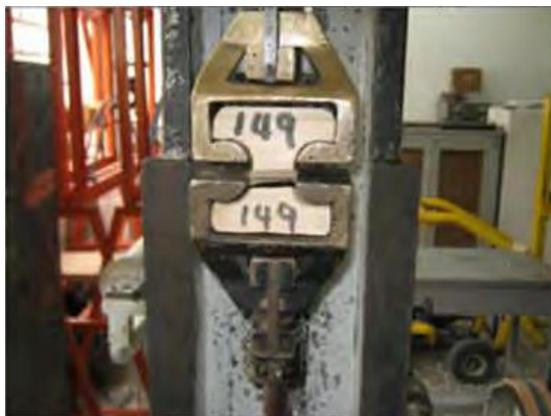
**FIGURA 10.11** Probeta de madera perpendicular al grano a la que se le realizara un ensayo de tracción. (Merchán, 2012)
