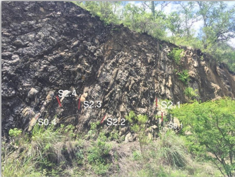
Figura 15. , que ilustra el plano de falla (traza roja) entre la Formación Ayuquila y la Formación Solano, la estratificación (traza negra) que presenta la Formación Solano en el contacto. Localidad 3 Proyección Schmidt, hemisferio inferior.
